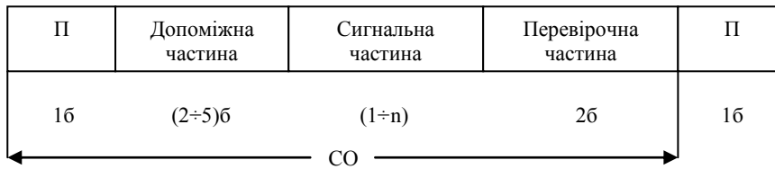
Рисунок 8 – Структура СО системи сигналізації ЗКС №7
