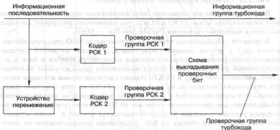
Рис. 2.10. Структура кодера турбокода
