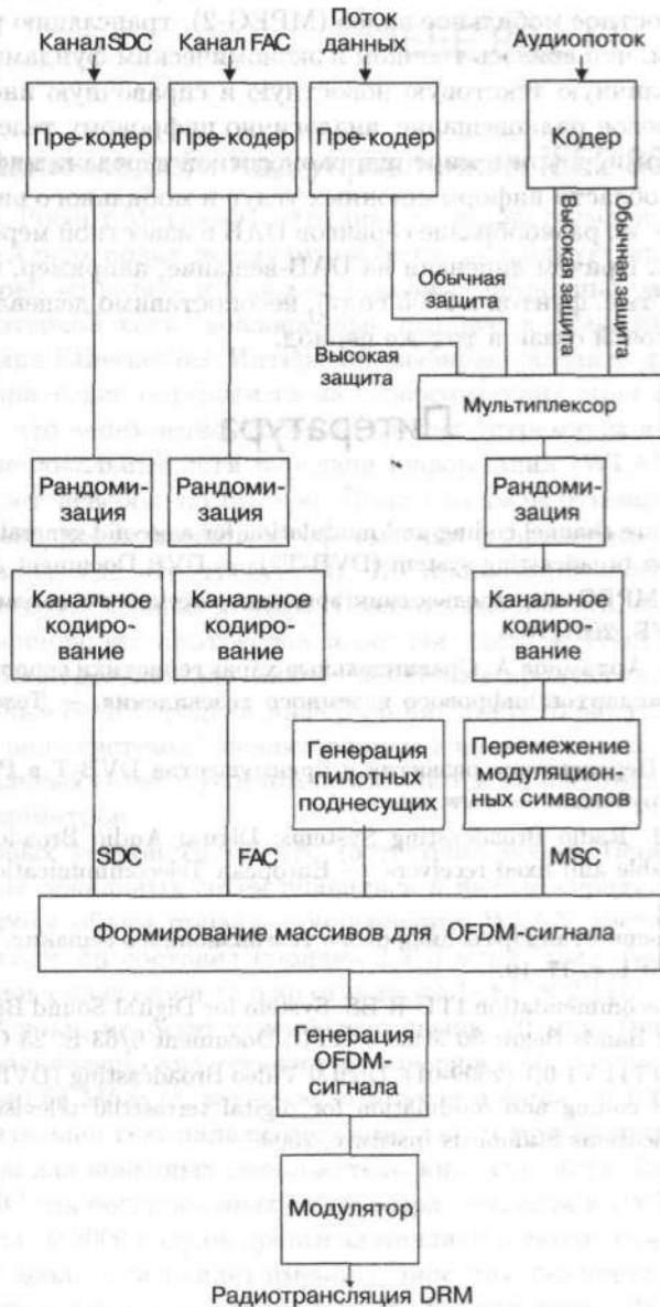
Рис. 4.25. Общая схема передачи данных DRM
