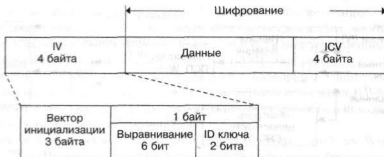
Рис. 5.41. Пакет после WEP-шифрования
