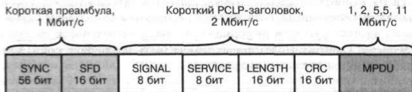
Рис. 5.8. Короткий заголовок кадров сети 802.11b
