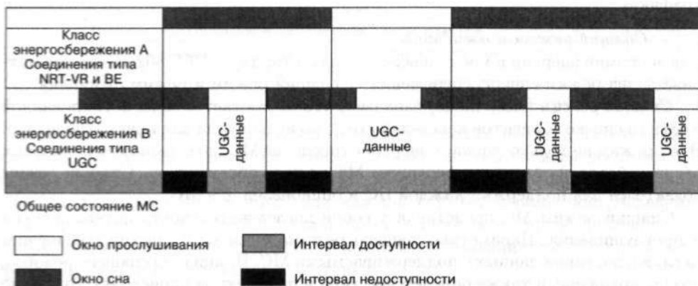
Рис. 7.27. Пример работы MC с двумя классами энергосбережения
