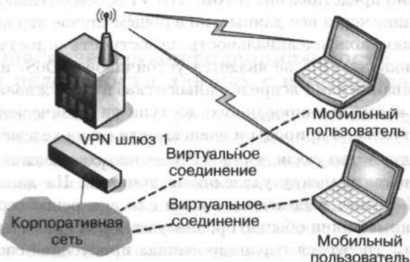
Рис. 5.49. Топология VPN «хост-сеть»
