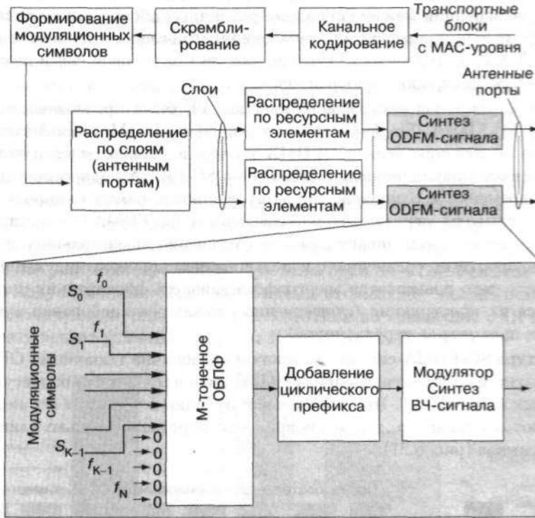
Рис. 6.20. Схема формирования сигнала в нисходящем канале
