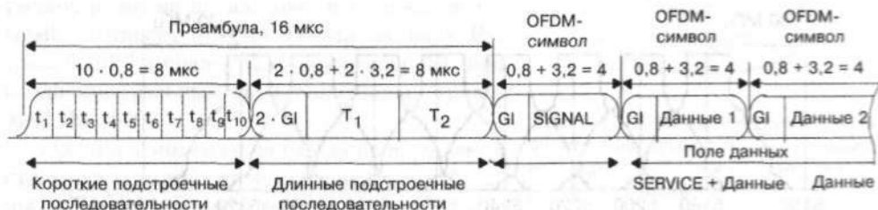
Рис. 5.17. Последовательность передаваемых данных в стандарте IEEE 802.11a
