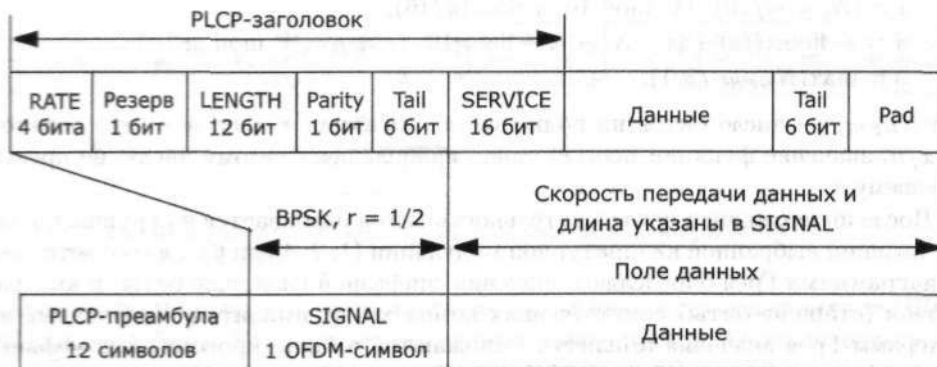
Рис. 5.16. Структура пакетов физического уровня стандарта IEEE 802.11a
