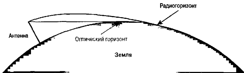
Рис. 5.7. Видимый горизонт для оптических волн и радиоволн
