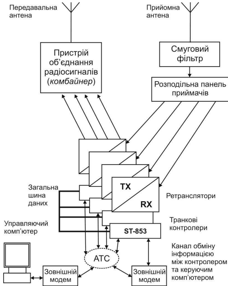
Рис. 6.2. Структурна схема базової станції SmarTrunk II
