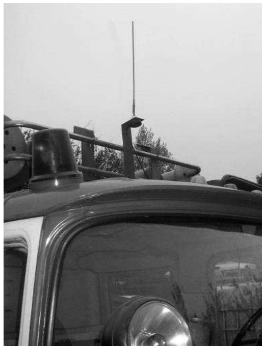
Рис. 3.20. Встановлення \lambda/4 штирової антени на даху пожежної автоцистерни АЦ-40(130)63Б
