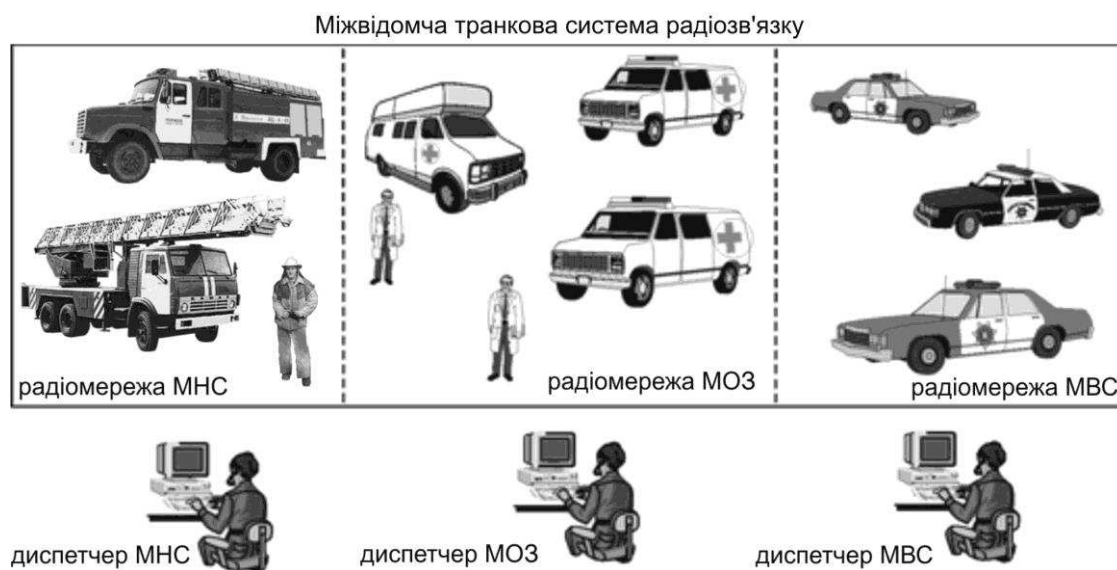
Рис. 6.23. Утворення віртуальних радіомереж всередині системи транкового радіозв'язку
