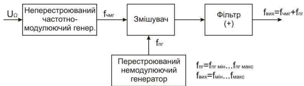
Рис. 2.26. Отримання інтервалу робочих частот f_{\max} \dots f_{\min} за допомогою інтерполяційної схеми
