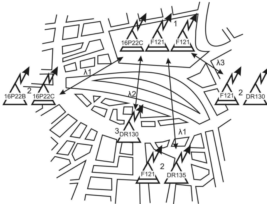
Рис. 7.4. Схема зв'язку, яка складається із радіонапрямів та радіомереж [2] 1 – радіостанція центрального пункту радіозв'язку; 2 – радіостанція ПЗЧ; 3 – радіостанція штабного автомобіля
