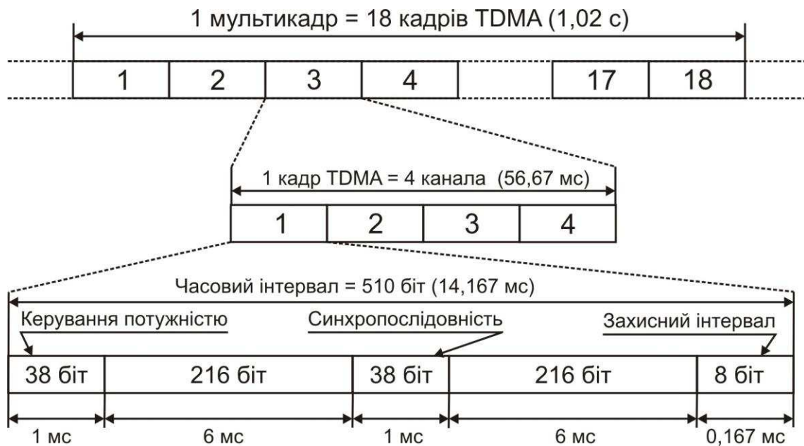
Рис. 6.20. Структура мультикадра TETRA
