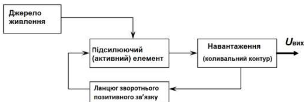
Рис. 2.4 – Узагальнена схема автогенератора
