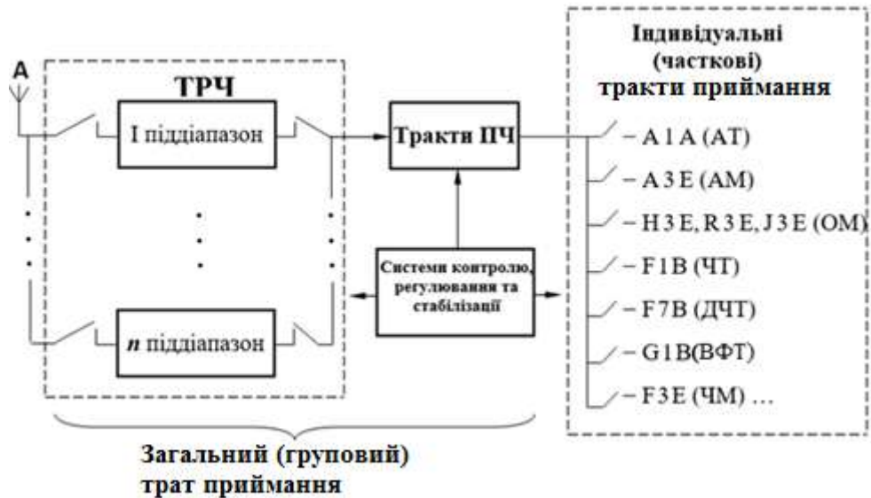
Рис. 3.9 – Узагальнена структурна схема професійного радіоприймача
