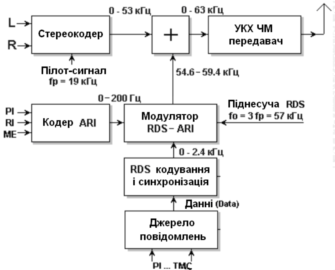
Рис.4.13 – Структура пристрою формування RDS -сигналу
