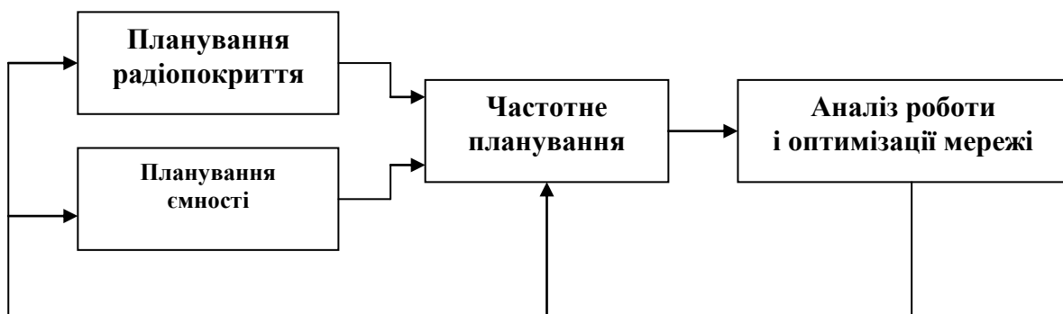
Рис. 20.1. Етапи планування мережі базових станцій
