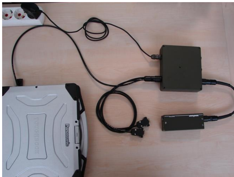
Рис. 4.34. Підключення пристрою FG-2070 для завантаження плану зв'язку
