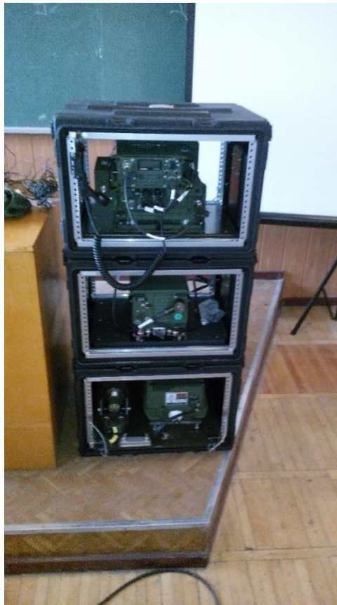
Рис. 5.30 Зовнішній вигляд КХ станції з підсилювачем 150 Вт
