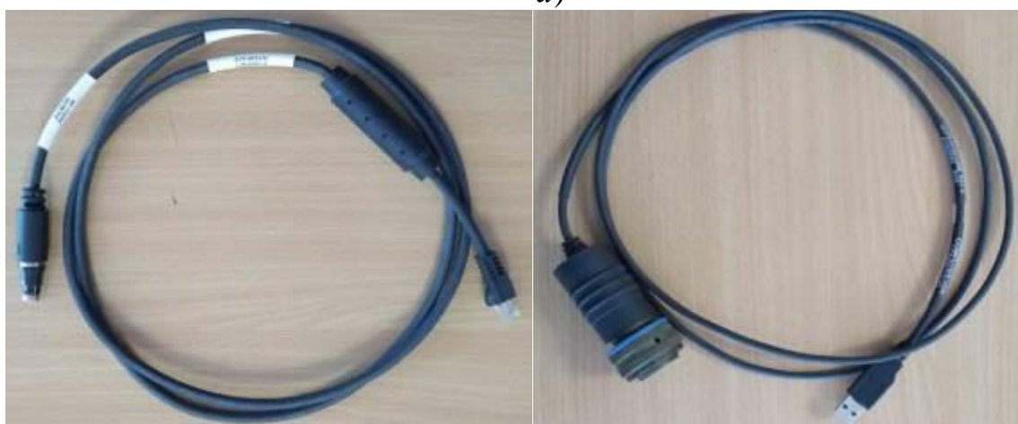
Рис. 5.76 Комплект для підключення до локальної мережі: а) кабель для з'єднання модуля LCU КДП з радіостанцією; б) кабель Ethernet (12078-0731-A006) 2 шт.; в) кабель USB (12078-0733-A006) – 1 шт.
