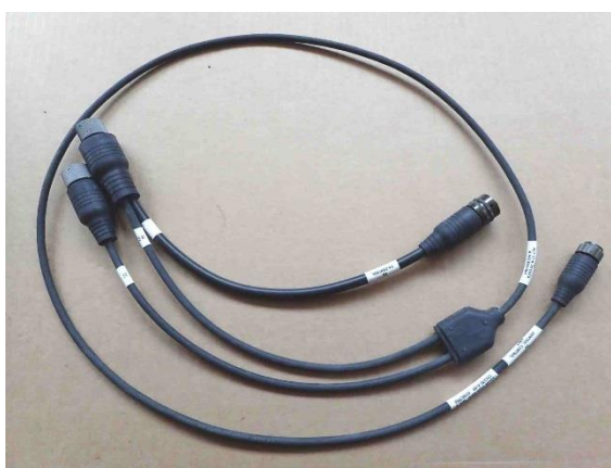
Рис. 5.133 Кабель підключення КХ радіостанції з підсилювачем 150 Вт до центрального блоку
