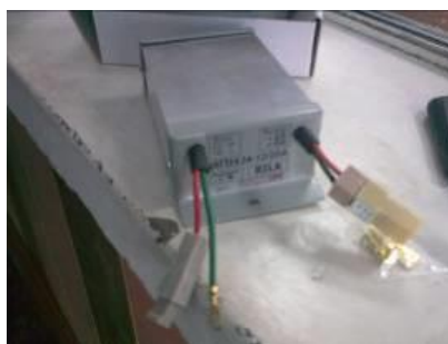
Рис. 2.71 Імпульсний перетворювач напруги ІПН 24-12/20А
