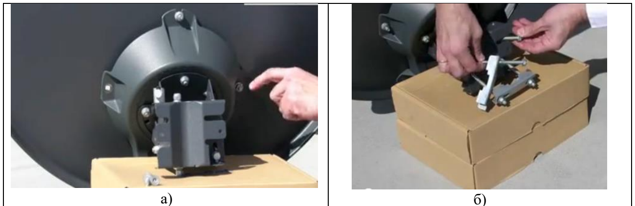
Рис. 1.10 Антена з прийомо-передавачем у розібраному вигляді
