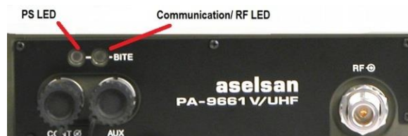
Рис. 4.14 Світлодіоди підсилювача потужності
