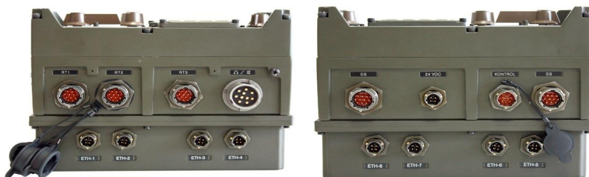
Рис. 4.68. Роз'єми основного блоку МВ-6680
