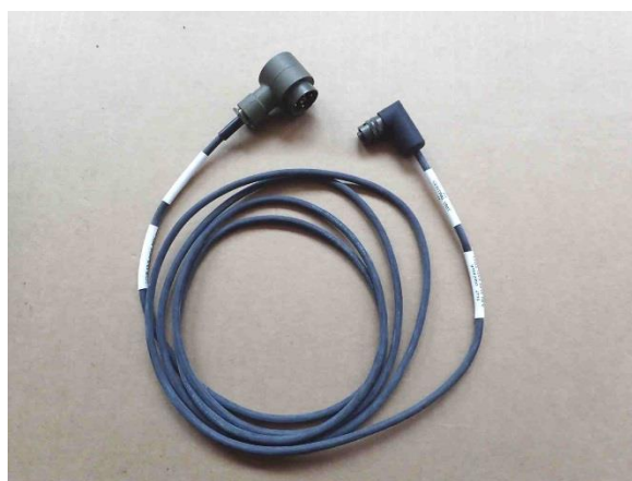
Рис. 5.136 Кабель живлення центрального блоку
