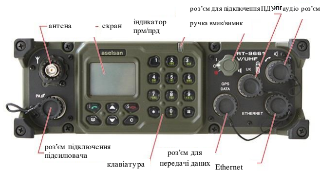
Рис. 4.5 Передня панель прийомопередавача радіостанції 9661
