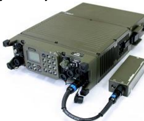
Рис. 4.35 Підключення пристрою FG-2070 до радіостанції
