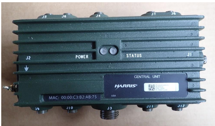
Рис. 5.112 Центральний блок RF-7800I-CU100 (Центральний блок в конфігурації для передачі голосу і даних )
