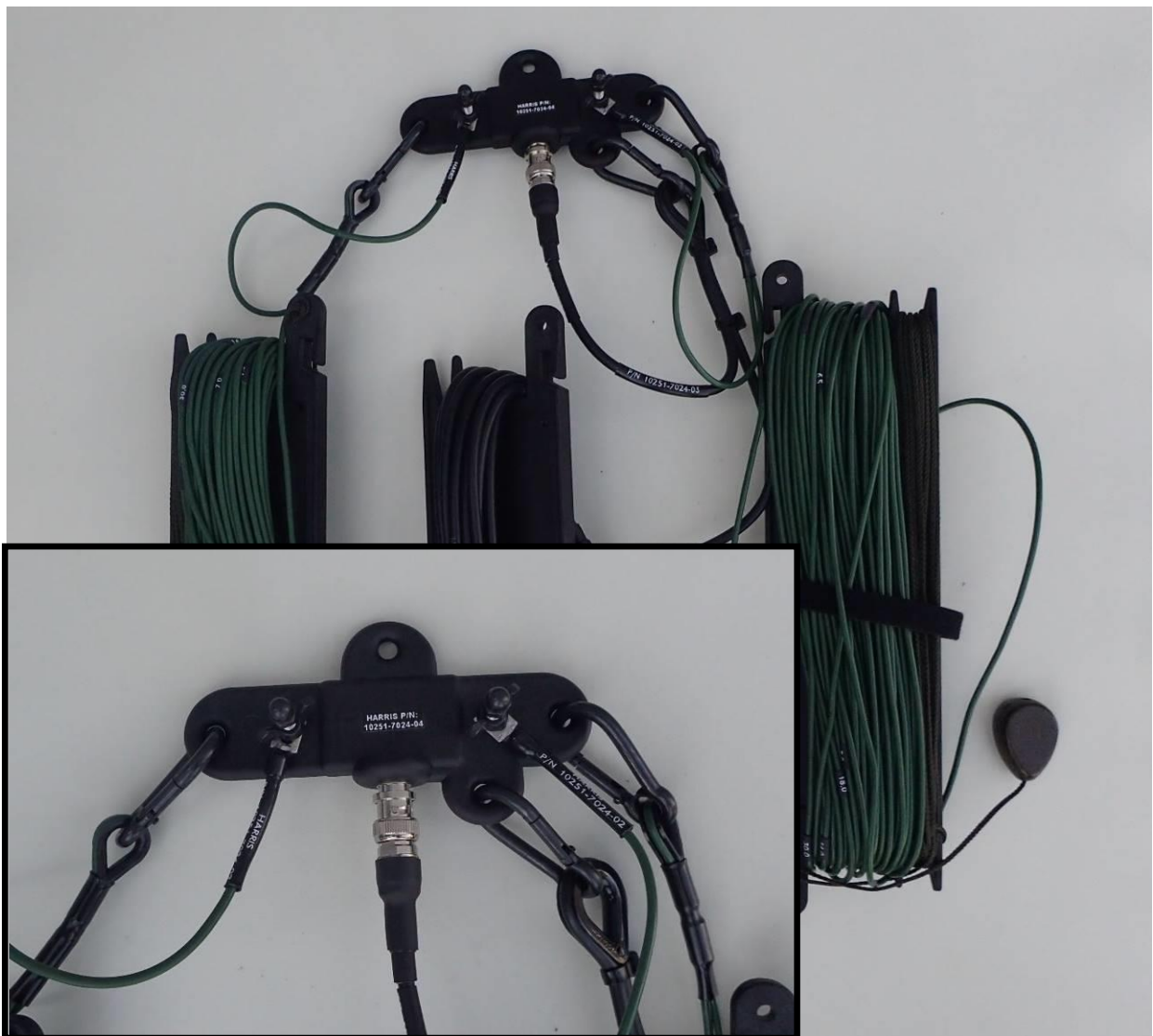
Рис. 5.29 Монтування антенного проводу та коаксiального кабелю до симетруючого пристрою
