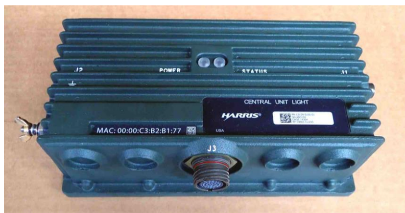
Рис. 5.113 Центральний блок RF-7800I-CU200 (Центральний блок в конфігурації для передачі тільки голосу)
