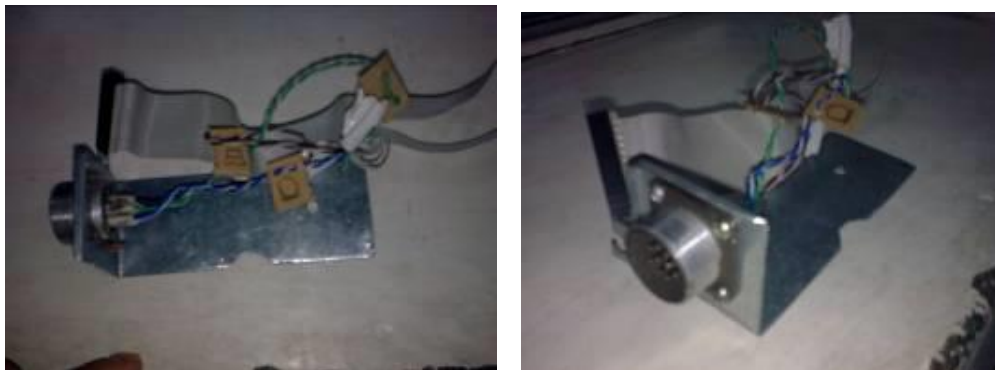
Рис. 6.4 Зовнішній вигляд варіанту кабелю для підключення радіостанції DM4600 до пульта радиста
