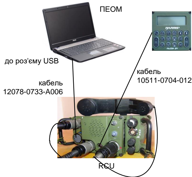
Рис. 5.87 Підключення складових RCU
