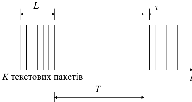
Рис.5.2. Ілюстрація структури тестового потоку пакетів для вимірювання величини параметра RTT
