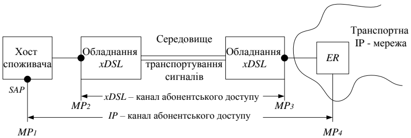
Рис.8.6. Схема вимірювань параметрів послуги абонентського доступу до транспортної IP -мережі з використанням обладнання xDSL
