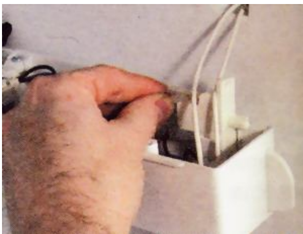
Рис. 27 Выньте выключатель освещения
