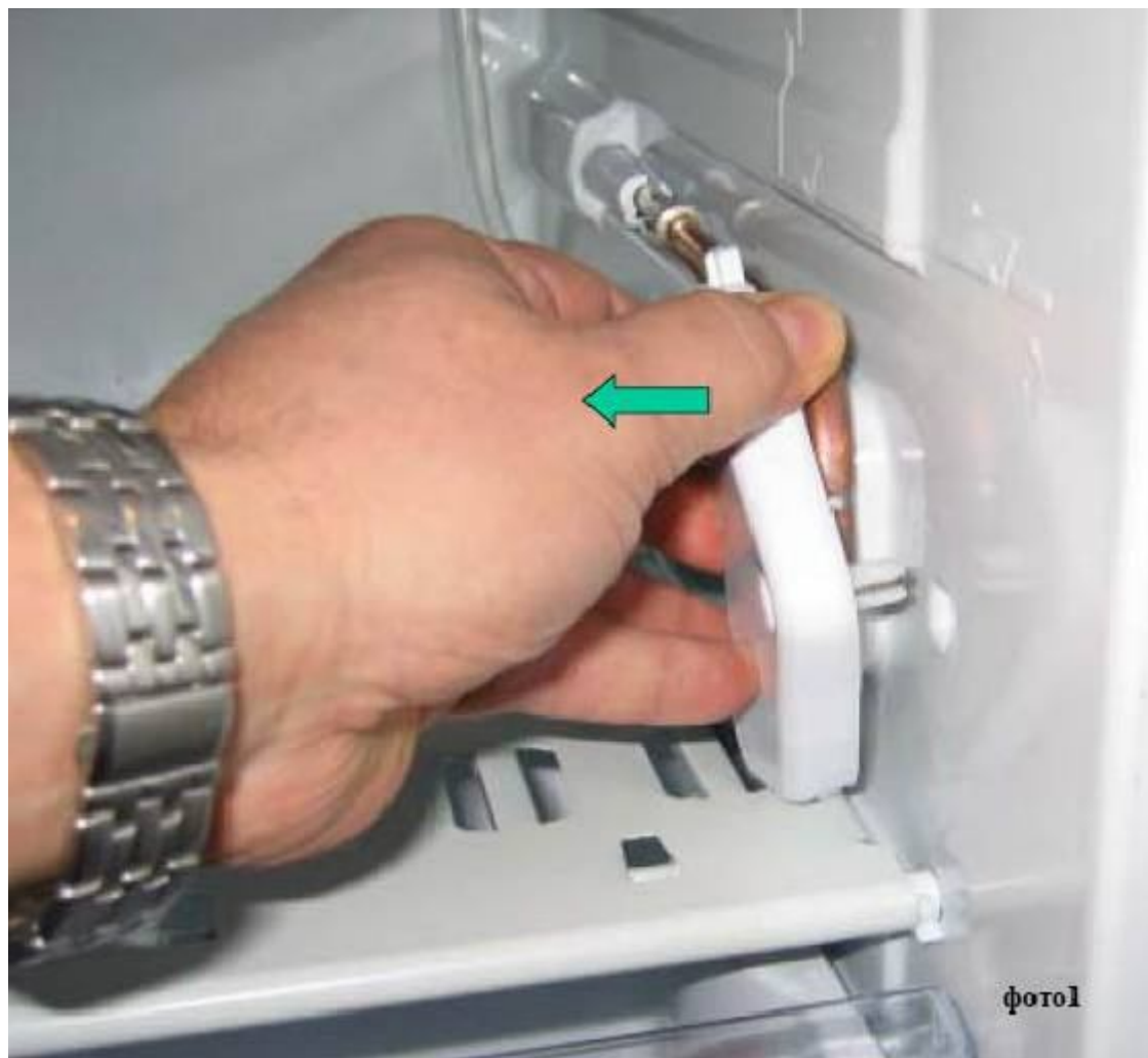
Рис. 1 Демонтаж декоративной накладки (стрелками показано направление приложения усилия)
