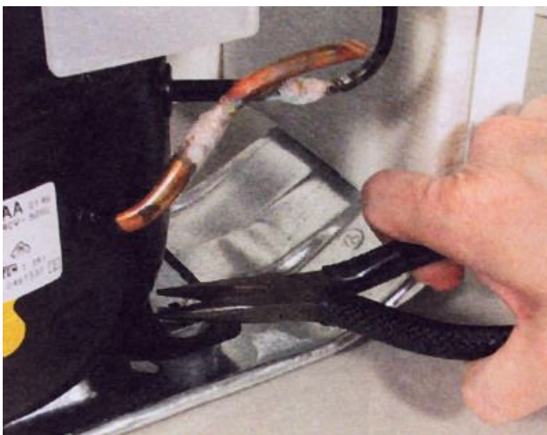
Рис. 18 От вибрации опоры компрессора могут разболтаться
