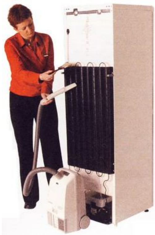
Рис. 31 Удалите пыль со змеевика конденсатора
