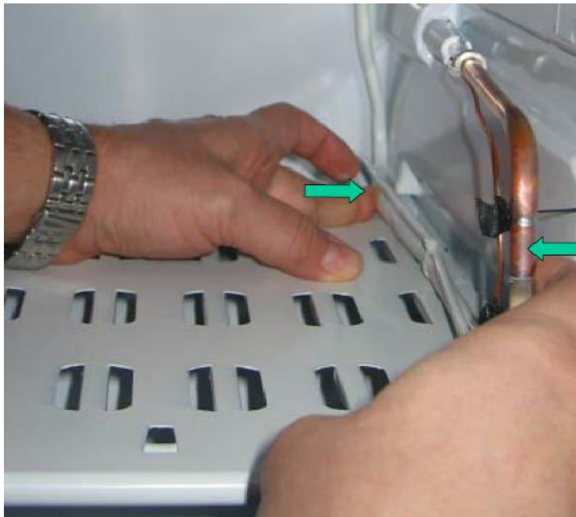
Рис. 2 Отгибание передней части трубопровода
