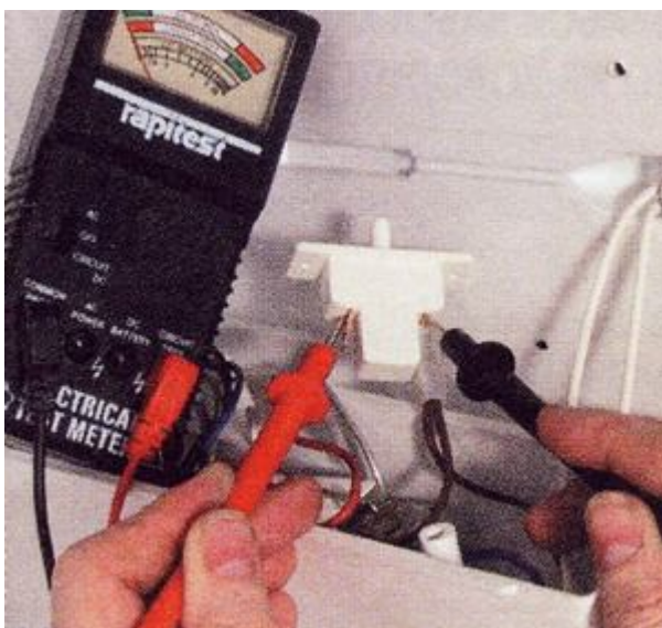
Рис. 28 Проверьте выключатель тестером
