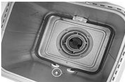
Рис. 2.6. Розташування деталей у пекарній камері: по периметру нижньої частини – нагрівальний елемент – ТЕН; на дні – муфта, в центрі якої – механізм, що крутить деталь (у вигляді чорного кружка)
