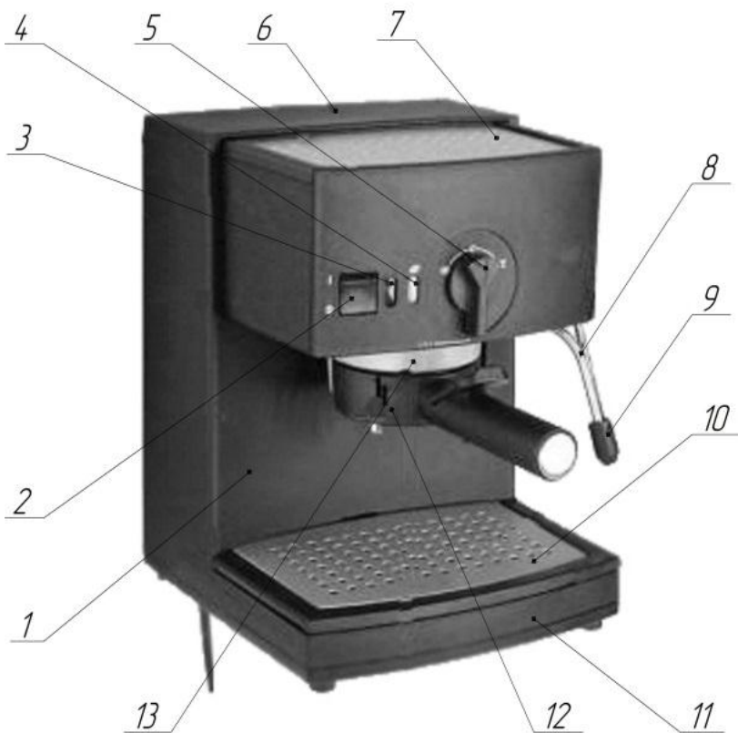
Рис. 3.11. Зовнішній вигляд та будова кавоварки еспресо: 1 – корпус; 2 – вимикач кавоварки; 3 – індикатор включення; 4 – індикатор температури; 5 – перемикач режимів; 6 – верхня кришка; 7 – верхня панель; 8 – трубка подачі пари; 9 – насадка подачі пари (капучинатор); 10 – решітка; 11 – лоток для збору води; 12 – тримач фільтра (ріжок); 13 – корпус дозатора
