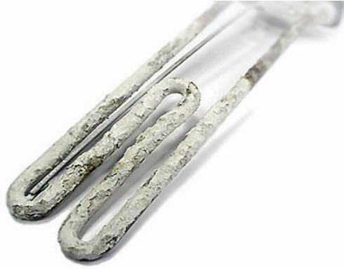
Рис. 2.6. Відкладення накипу на термоелектронагрівнику (ТЕН)
