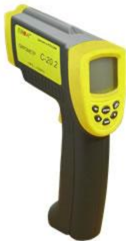
Рис. 7.4. Інфрачервоні пірометри: а) «Смотрич»; б) «НІМБУС»; в) «Німбус-530/1»; г) «ДПР-1»; д) «С-20.2»; е) «ПИТОН-102»
