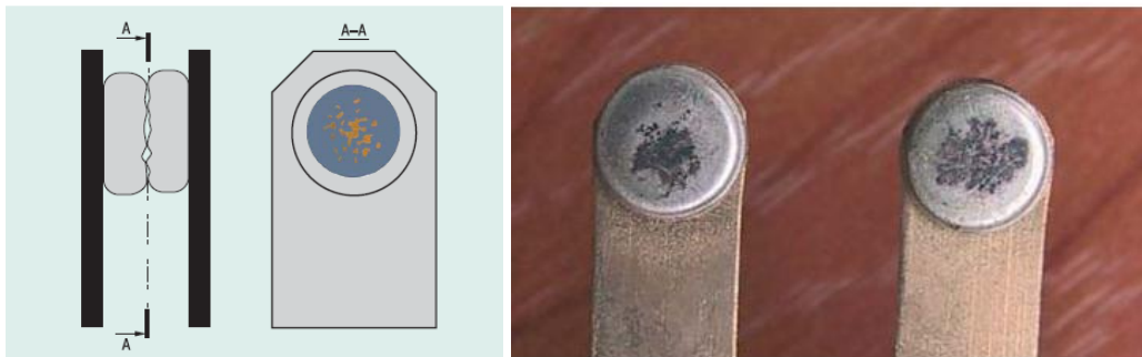
Рис. 2.4. Контакти електромагнітного реле: а) умовне зображення замкнутих контактів електромагнітного реле; б) вигляд контактів реле, що працювали певний час
