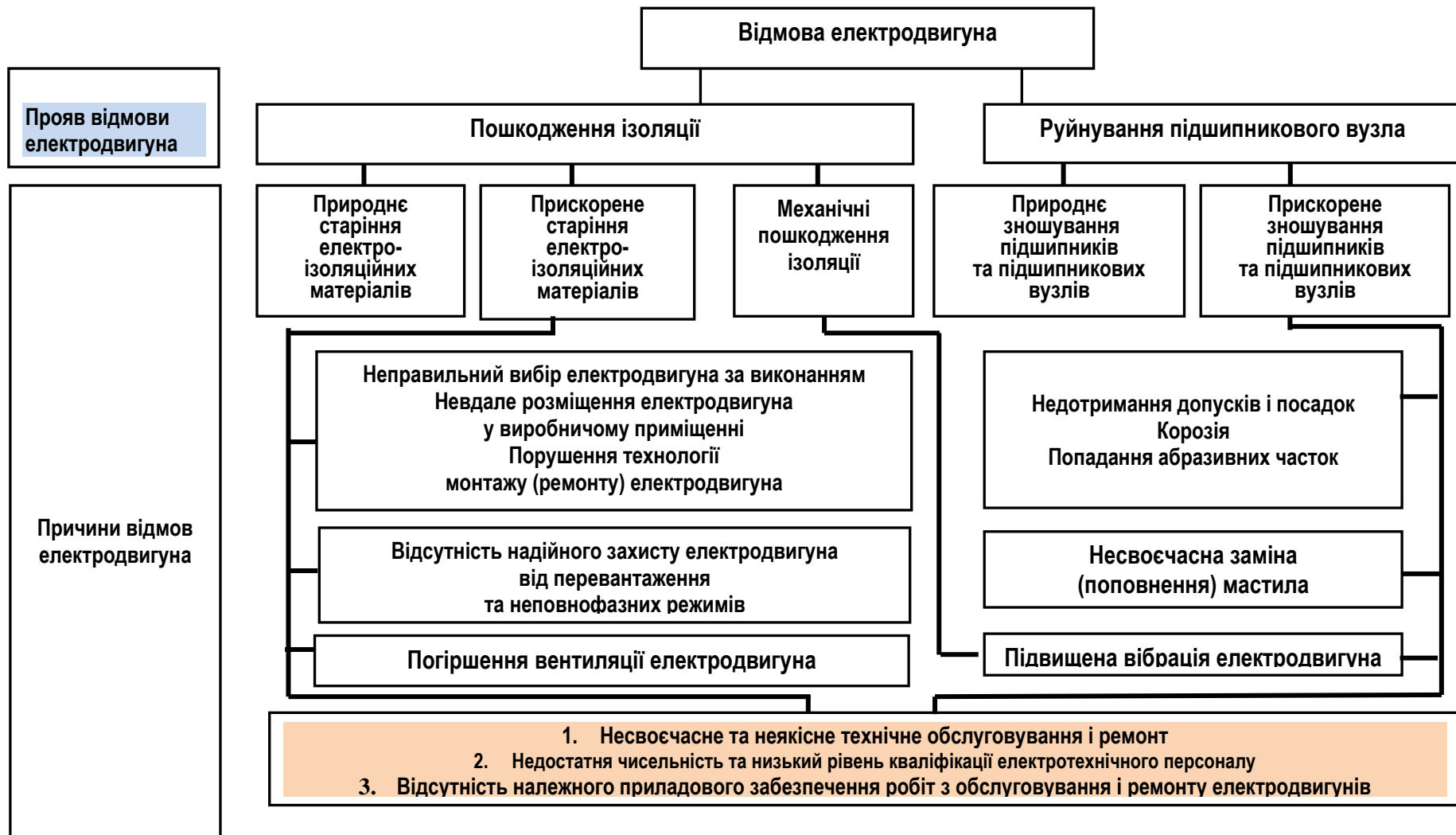
Рис. 2.2. Класифікація причин відмов електродвигунів в умовах експлуатації
