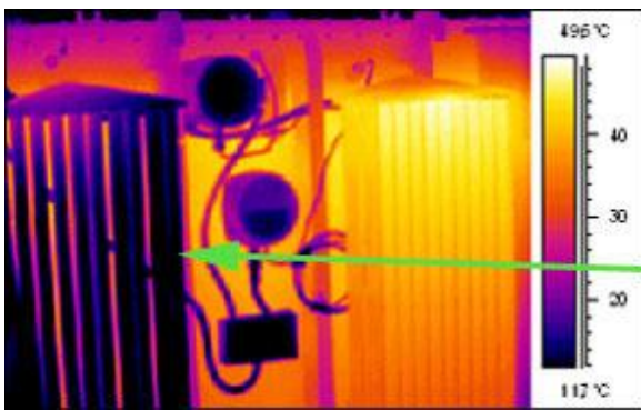
Порушення циркуляції масла в радіаторі теплообмінника трансформатора
