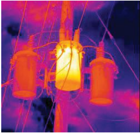
Виділення надлишкового тепла в розподільному трансформаторі внаслідок появи внутрішнього дефекту й низького рівня масла
