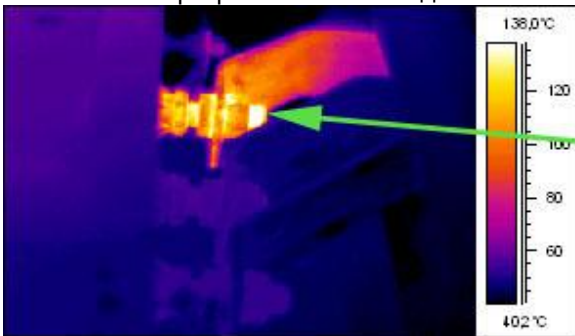
Перегрів болтового з'єднання шинного моста трансформатора
