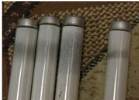
Рис. 2.5. Люмінесцентні лампи з пошкодженнями люмінофору
