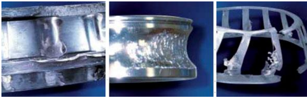
Рис. 2.3. Деякі пошкодження підшипників, викликані використанням неправильно підбраного мастила
