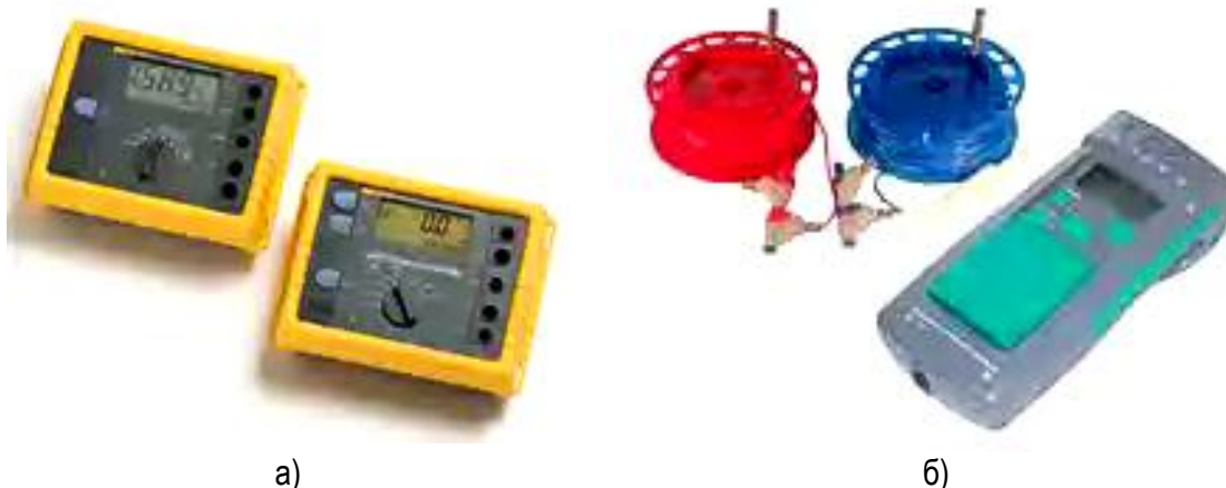
Рис 1.39. Вимірювачі опору заземлення: а) Fluke серії 1620 GEO; б) ИС–10
