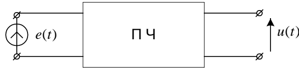
Рис.4.18. Подання схеми під час перехідного процесу за допомогою інтеграла Дюамеля
