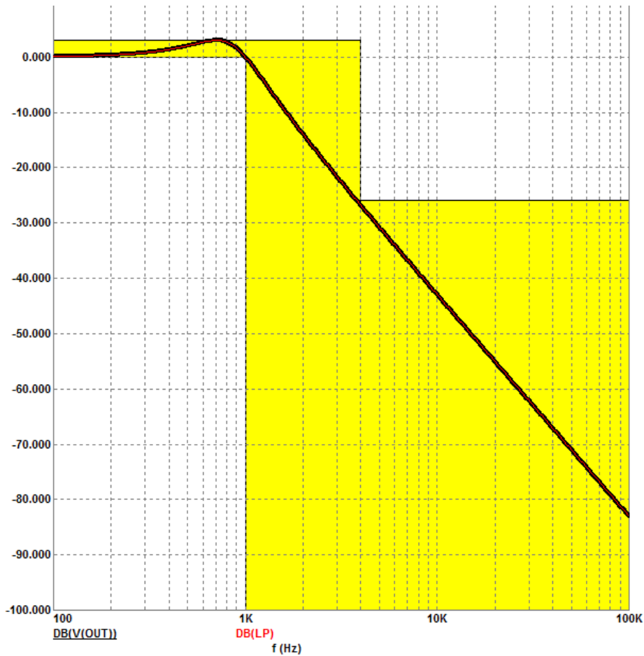
Рис. Д.10. АЧХ фільтра Чебишева 2-го порядку з рівнем пульсації в смузі пропускання 3 дБ і з загасанням при \Omega = \omega/\omega_c = 4 не менше 29 дБ
