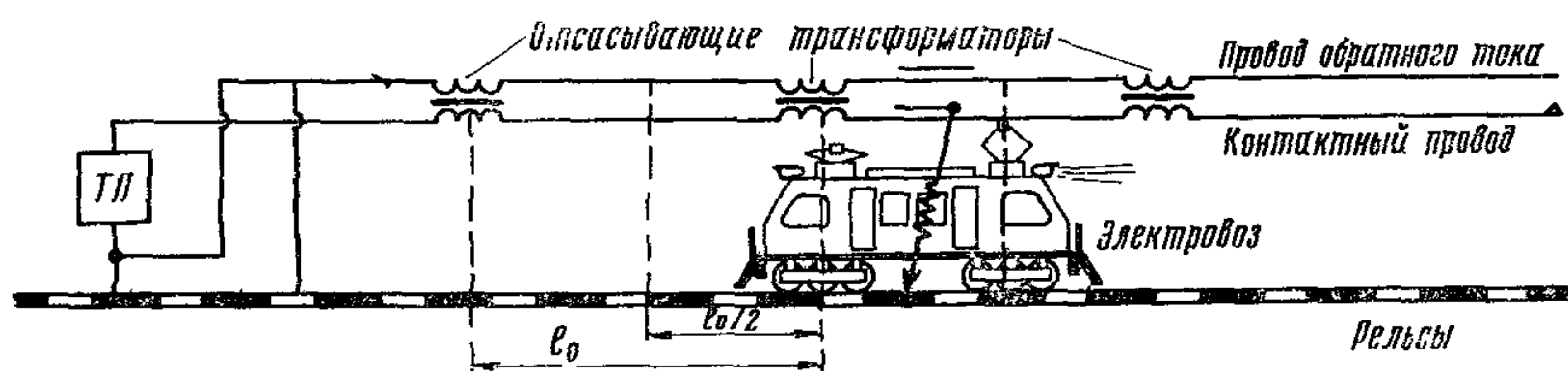
Рис 2.15. Включение отсасывающих трансформаторов, включенных по схеме с обратным проводом
