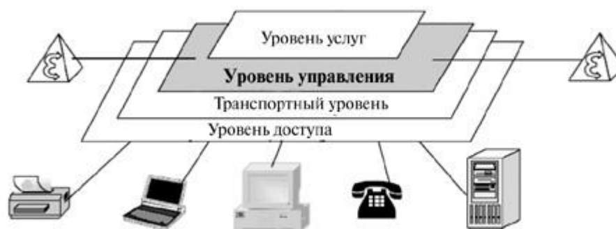
Рис. 11.1. Архитектура сети следующего поколения
