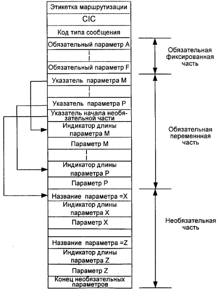
Рис. 6.54. Структура параметров в ISUP
