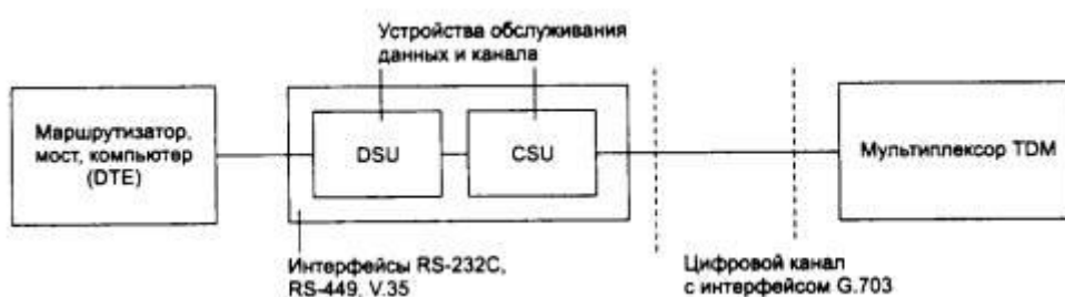
Рис. 8.9. Использование DSU/CSU для подключения к цифровой выделенной линии
