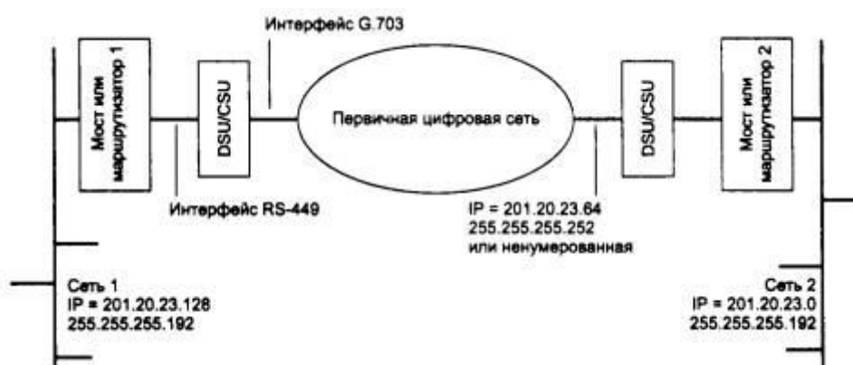
Рис. 8.11. Соединение сетей с помощью выделенного канала
