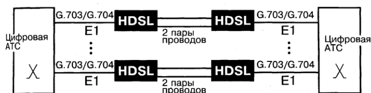
Рис. 9.14. Межстанционная связь между цифровыми АТС
