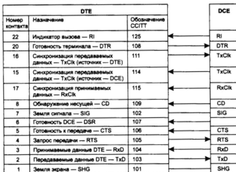
Рис. 8.3. Сигналы интерфейса RS-232C/ V.24
