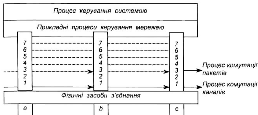
Рисунок 2.2 – Вузол комутації: (а, б, с - абоненти; штрихові лінії - процеси логічного з'єднання; суцільні - процеси фізичного з'єднання)
