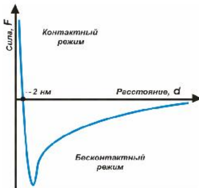
Рис.2.13 Зависимость силы межатомного взаимодействия от расстояния между острием и образцом.
