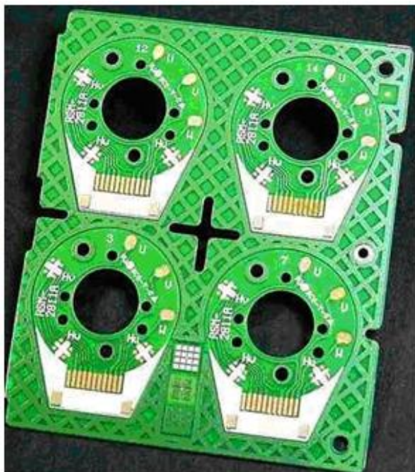
Рис. 1.35 Примеры односторонних плат.
