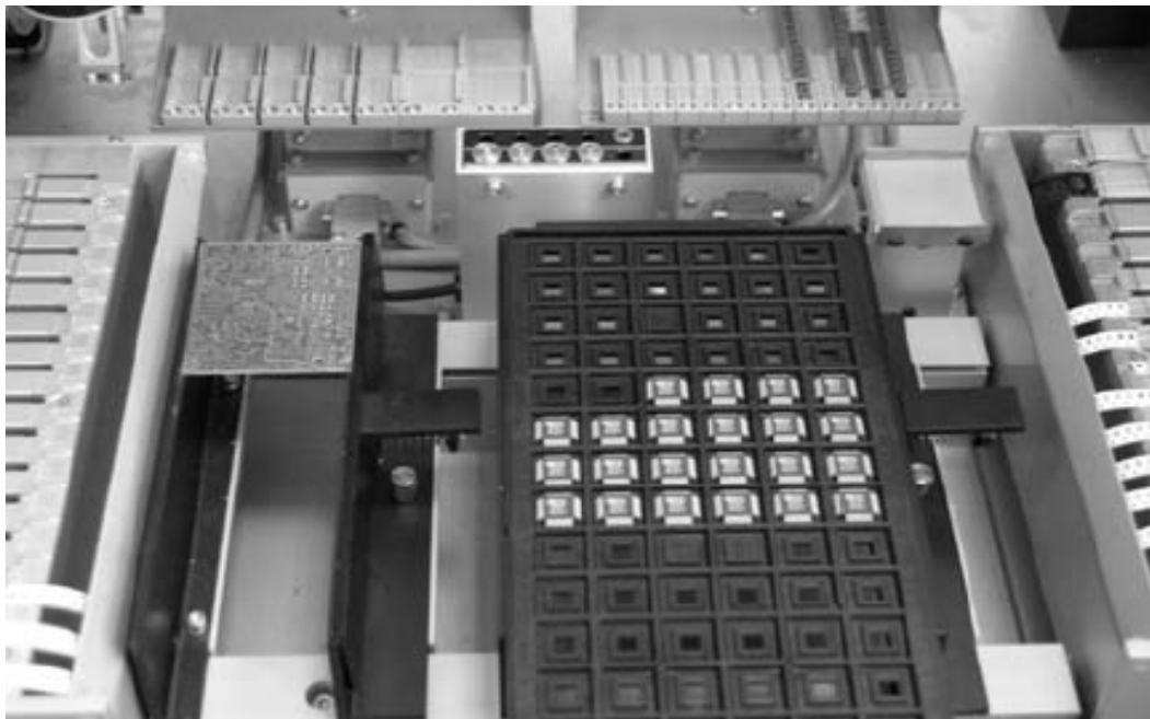
Рис. 33. Установка компонентов с палет
