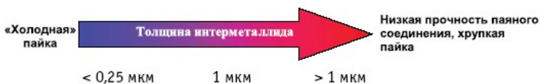
Рис.3.Зависимость прочности паяльного соединения от толщины интерметаллида
