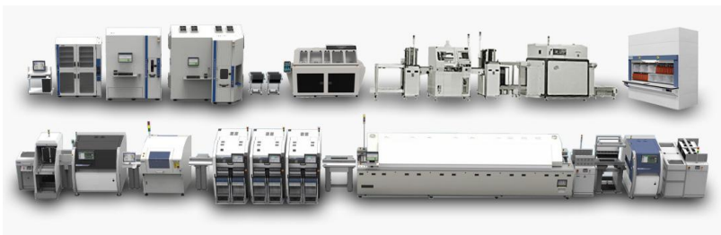
Рисунок 3.2 – Автоматична потокова лінія виробництва друкованих плат, складена компанією SOVTEST ATE
