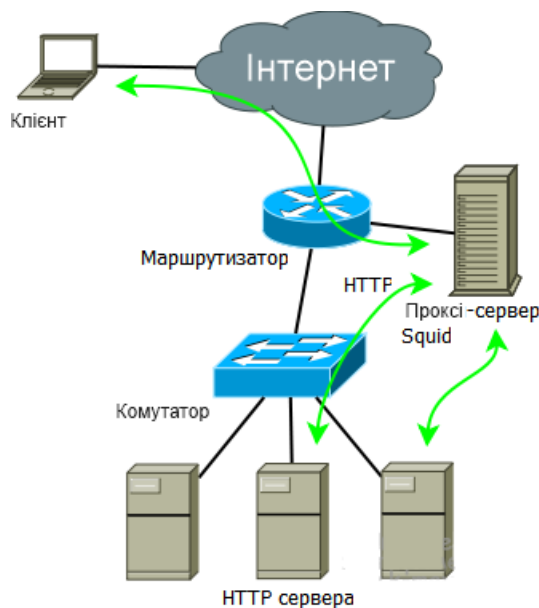
Рисунок 3.15 – Режим роботи зворотного проксі серверу
