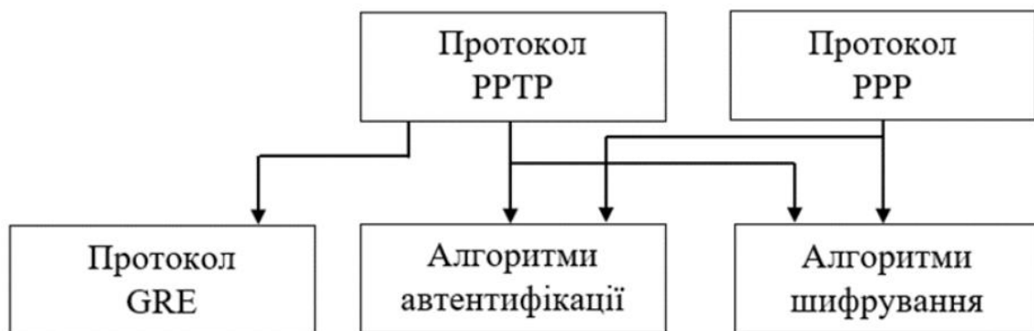
Рисунок 5.5 – Архітектура протоколу PPTP
