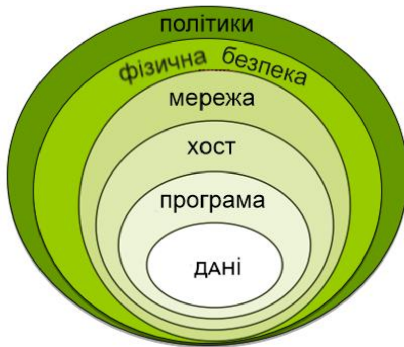
Рисунок 1.1 - Багаторівневий підхід в побудові системи захисту ІТС (Defense in Depth).
