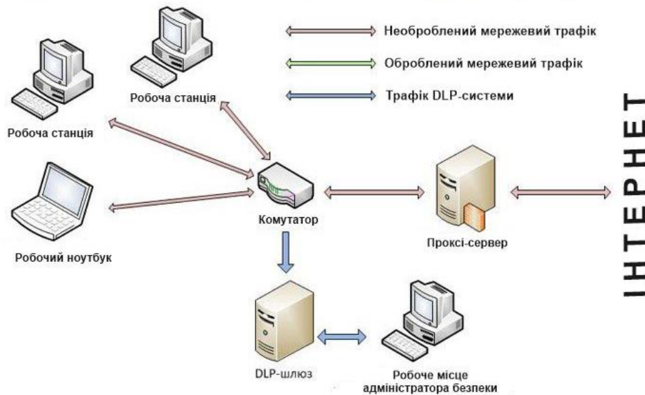
Рисунок 4.5 – Шлюзова DLP-системи, що працює в режимі моніторингу
