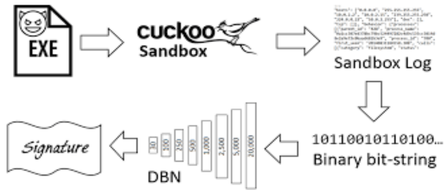
Рисунок 4.15 – Порядок аналізу файлів за допомогою Cuckoo Sandbox
