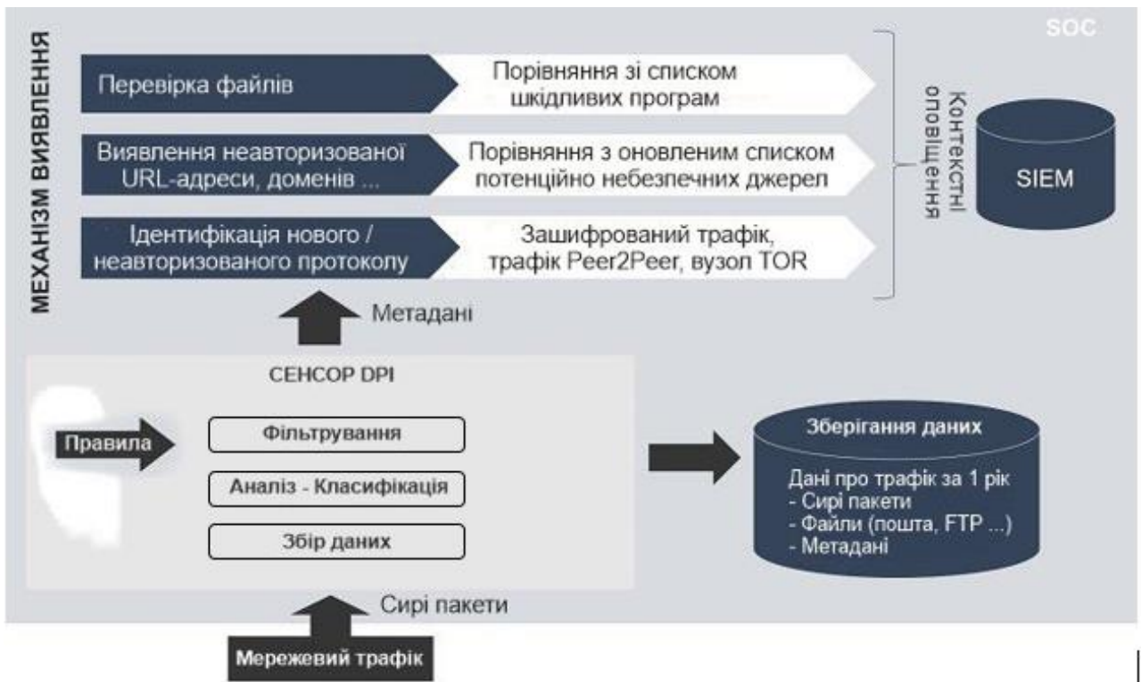
Рисунок 2.7 – Типова схема роботи NTA
