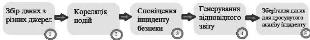
Рисунок 4.16 – Робочий процес SIEM
