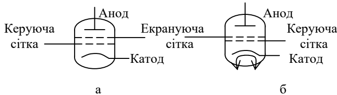
Рис. 2.4.5. Умовні графічні зображення електровакуумного тетрода:
