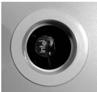
Рис. 21.26. Посмотрев через отверстие, оцените расстояние до верхней границы радиатора
