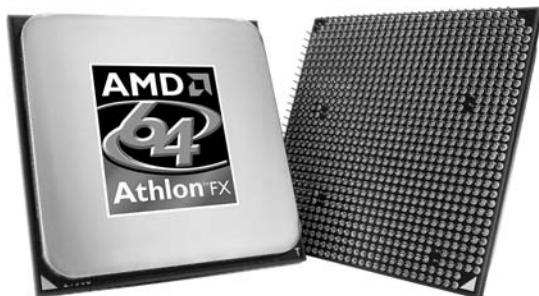
Рис. 3.63. Процессор AMD Athlon 64 FX (Socket 939). Фотография любезно предоставлена компанией AMD
