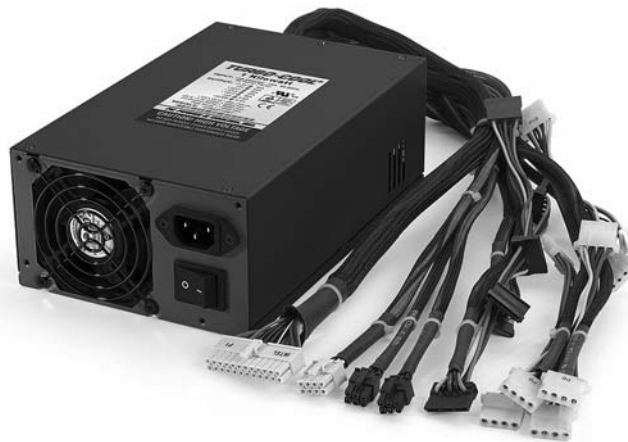
Рис. 19.12. Блок питания Turbo-Cool 1KW формфактора EPS12V ( www.pcpowercooling.com )
