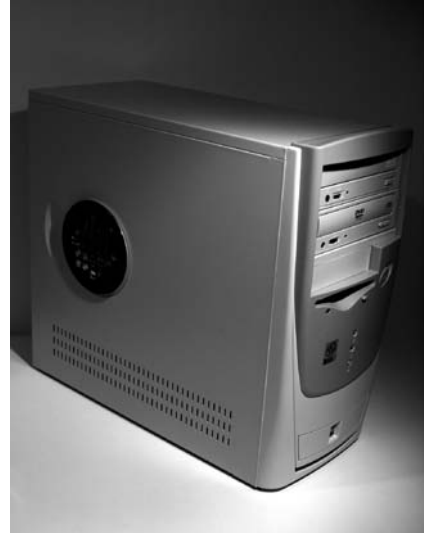
Рис. 21.28. Вид сбоку системного блока, боковая крышка которого содержит воздухозаборник
