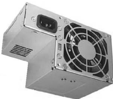
Рис. 19.14. Блоки питания TFX12V симметричны и допускают установку вентилятора как слева, так и справа
