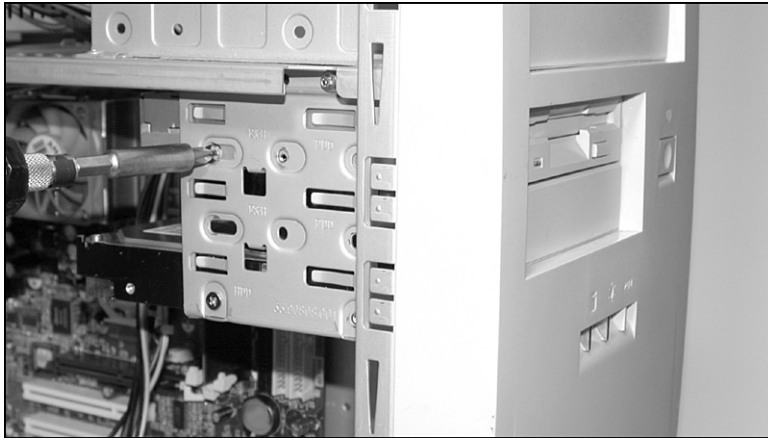
Рис. 20.24. С помощью винтов закрепите накопители в соответствующих отсеках (по четыре винта на каждый накопитель). При использовании съемных отсеков накопители таким же образом устанавливаются в системный блок
