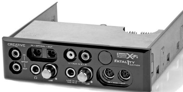
Рис. 14.3. Выносной блок аудиоадаптера Creative Sound Blaster X-Fi Fatalty содержит разъемы подключения MIDI-устройств, цифровые входы и выходы, удобные регуляторы громкости, стандартные гнезда линейного входа и выхода, подключения наушников, а также поддержку инфракрасного сигнала пульта дистанционного управления. Фотография публикуется с любезного разрешения Creative Technology, Ltd.
