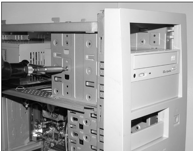
Рис. 20.23. Закрепите накопитель в корпусе, закрутив четыре винта
