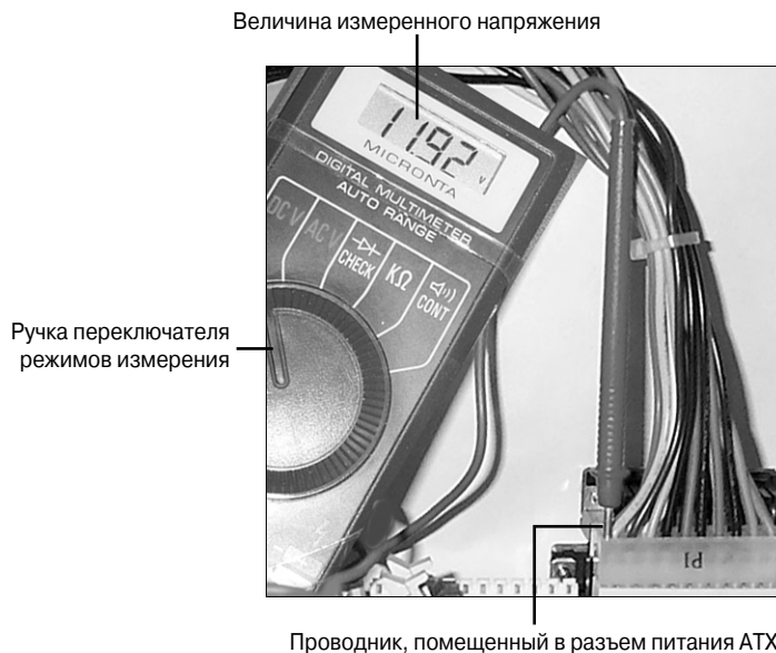
Рис. 22.8. Типичный цифровой мультиметр, используемый для тестирования 12-вольтовой цепи системной платы
