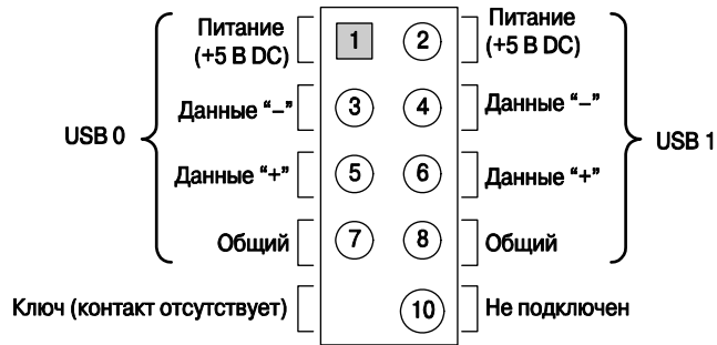
Рис. 4.53. Схема размещения контактов стандартного разъема для подключения двух портов USB
