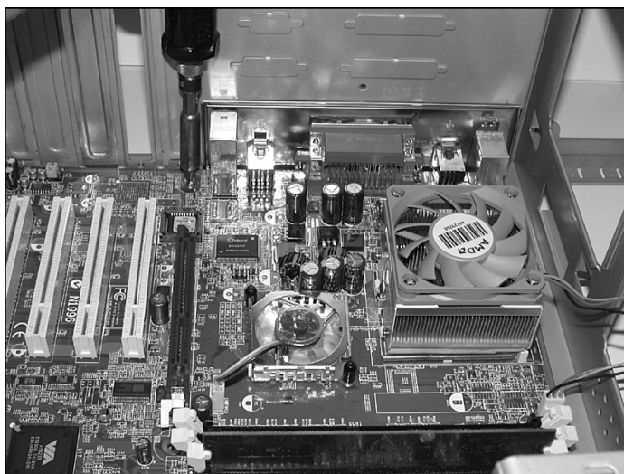
Рис. 20.17. Привинтите системную плату к корпусу
