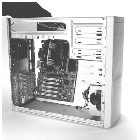
Рис. 20.16. Установка системной платы в корпус. Корпус предоставлен компанией PC Power & Cooling, Inc. Системная плата предоставлена компанией Intel Corporation
