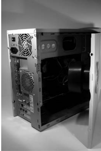
Рис. 21.27. Боковая крышка с воздухозаборником перед установкой
