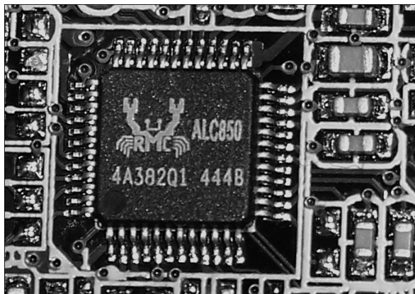
Рис. 14.6. Realtek ALC850 представляет собой типичную микросхему кодека AC'97 с поддержкой объемного звука 2.3
