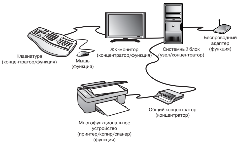
Рис. 15.3. В компьютере может использоваться несколько концентраторов USB для подключения различных периферийных устройств, причем любое устройство можно подсоединить к любому концентратору
