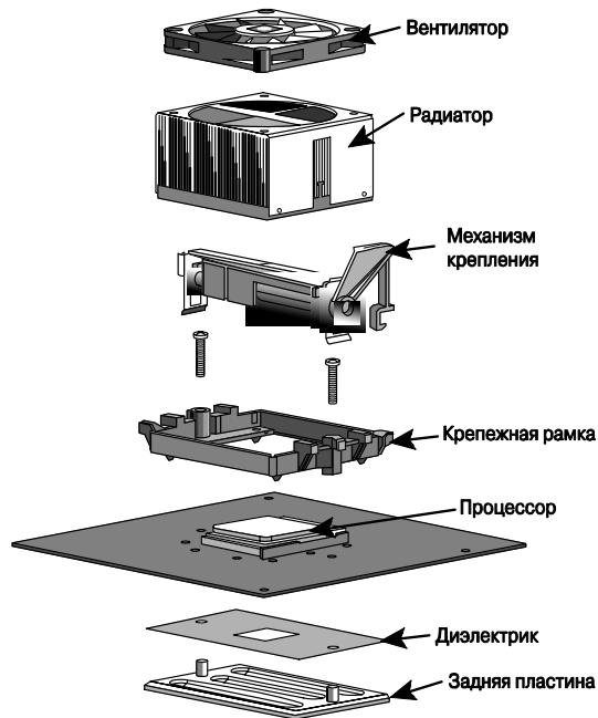
Рис. 21.10. Активный радиатор, предназначенный для охлаждения процессоров Athlon 64, Athlon 64 FX и Opteron. Подходит для процессоров, устанавливаемых в разъемы Socket 754, Socket 939 и Socket 940
