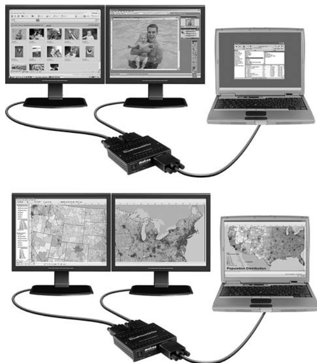
Рис. 13.19. Использование устройства Matrox DualHead2Go для запуска нескольких приложений (вверху) или для отображения одной программы на экранах нескольких мониторов (внизу). Фотографии предоставлены компанией Matrox Graphics
