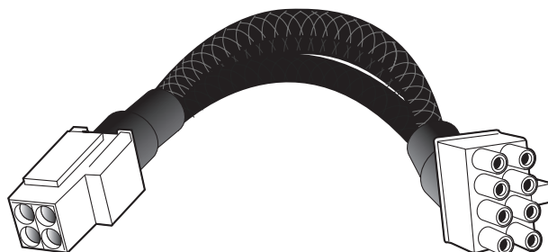
Рис. 19.29. Адаптер, соединяющий 4-контактный терминал блока питания и 8-контактный разъем материнской платы
