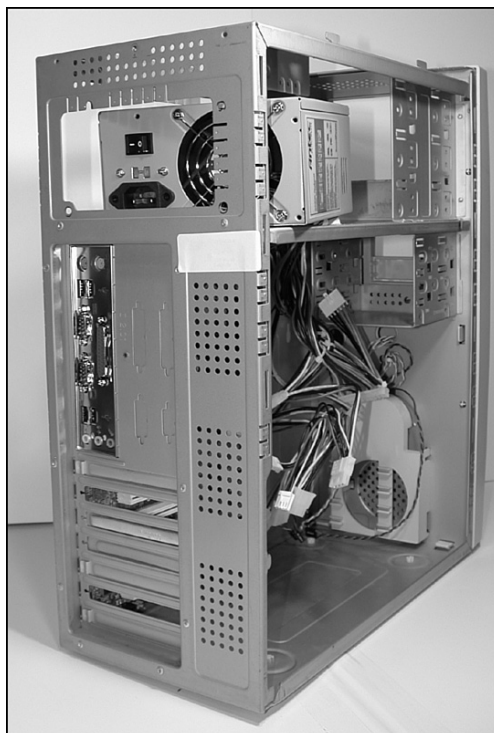
Рис. 20.18. Поместите блок питания в корпус
