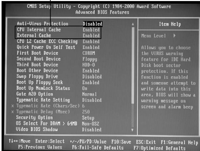
Рис. 6.20. Параметры CPU Internal Cache (L1) и CPU External Cache (L2) должны быть отключены в программе настройки BIOS до выполнения проверки памяти; в противном случае результаты тестирования могут оказаться неточными
