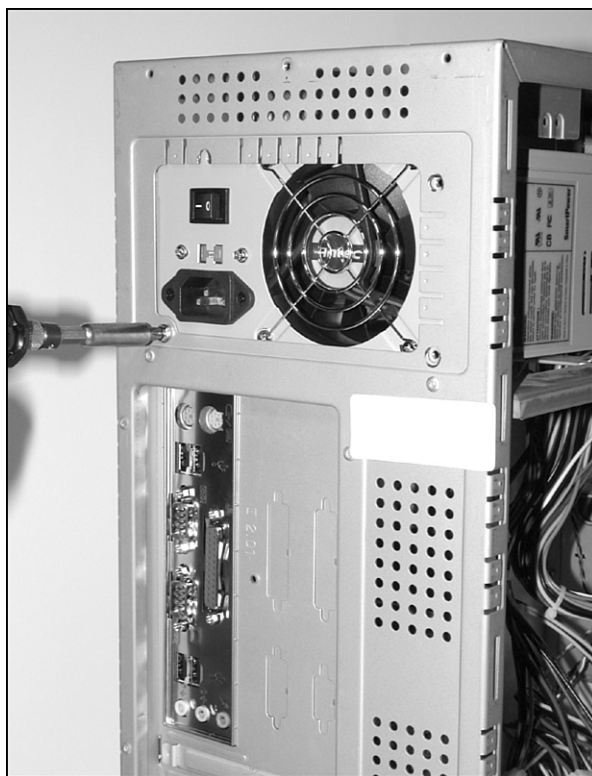
Рис. 20.19. Закрутите винты, удерживающие блок питания
