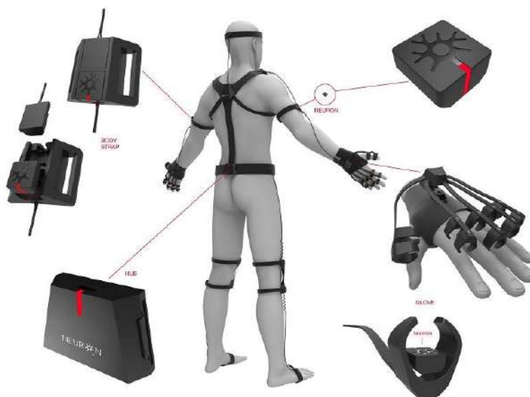
Рисунок 11.72 – Гіроскопічні/інерціальні системи Mo-cap
