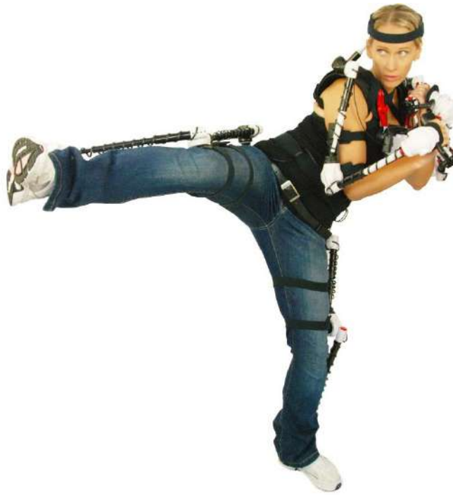
Рисунок 11.71 – Механічні системи Mo-cap
