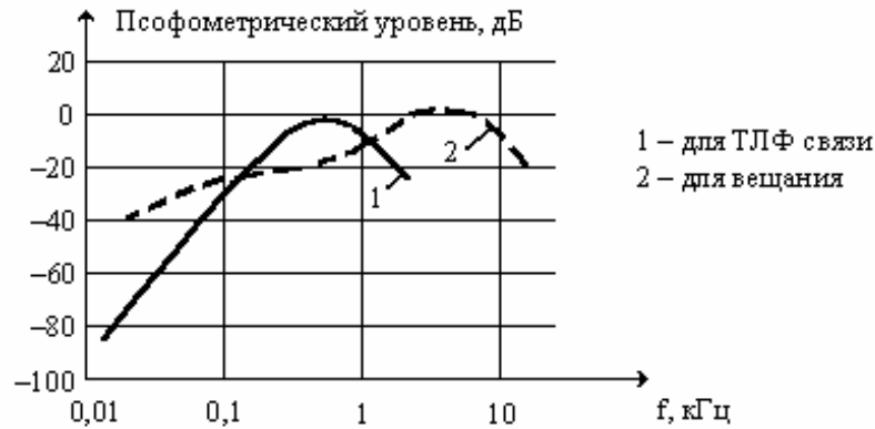
Рис. 5. АЧХ псофометрического фильтра.
