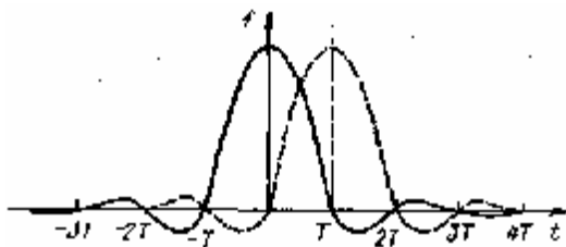
Рис. 10.2. Типичная импульсная реакция канала с ограниченной полосой частот
