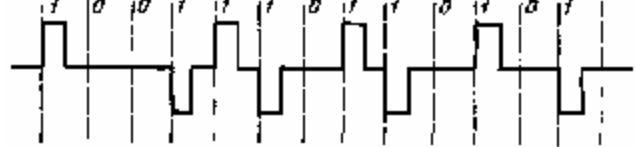
Рис. 10.6. Код с чередованием полярности импульсов Код с чередованием полярности импульсов
