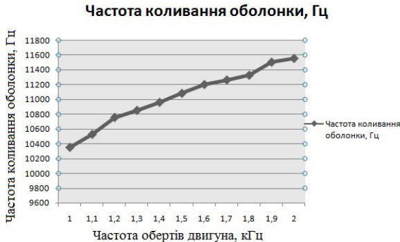
Мал. 1 – Результати дослідження частоти коливання оболонки при зміні частоти обертів двигуна.
