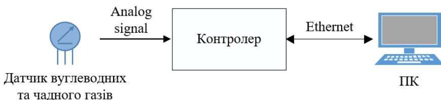
Рисунок 1 – Структурна схема системи моніторингу повітря
