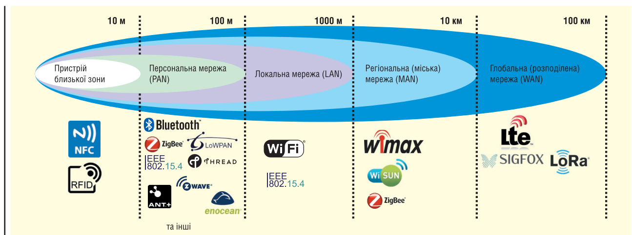
Рис. 2. Місце Wi-Fi відносно інших бездротових IoT-технологій
