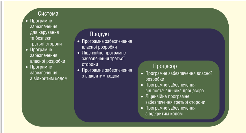
Рис. 1. Ланцюг постачання програмного забезпечення для продуктів IoT є складним, що створює труднощі з відстеженням усіх компонентів
