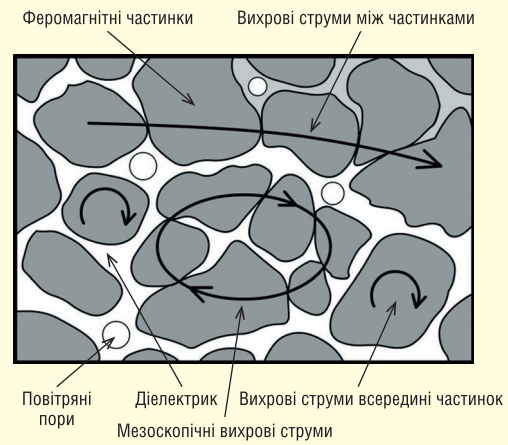
Рис. 9. Вихрові струми, що виникають у МПМ [30]
