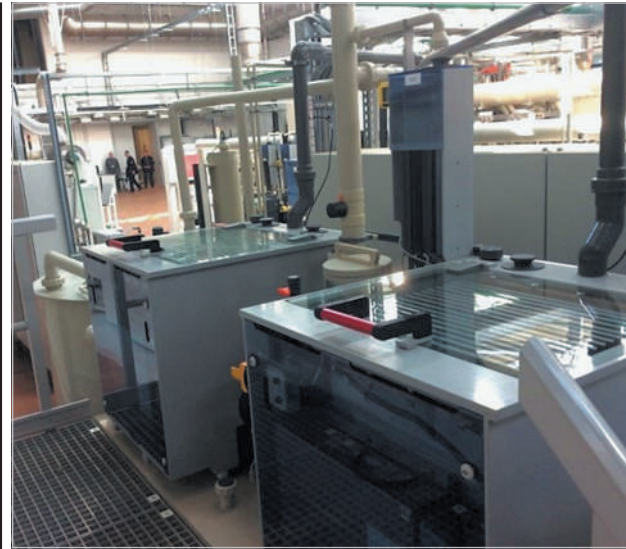
Рис. 7. Система регенерації травильного розчину компанії Sigma
