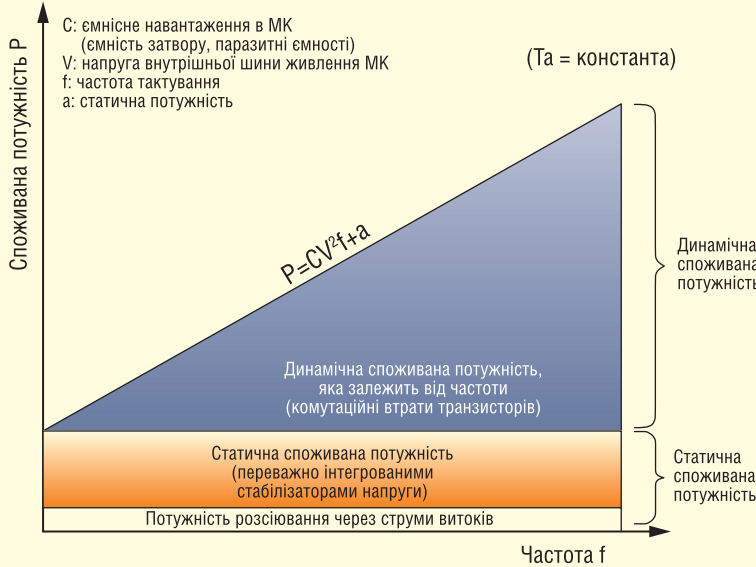
Рис. 4. Втрати потужності в цифровій НВІС
