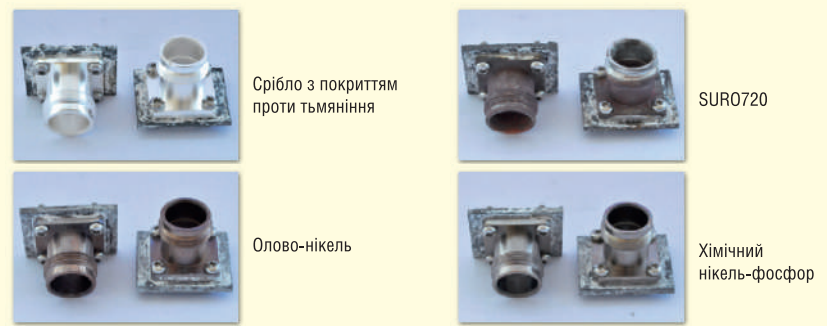
Рис. 7. Корозія зразків після випробувань в соляному тумані 720 годин на алюмінії (без ізоляції)
