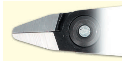
Рис. 3. КНП.7962125ESD. Крупний план конічних лез з невеликою фаскою — для різання врівень
