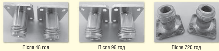
Рис. 5. Стандартна біла бронза (триметал) після 48, 96 і 720 годин випробувань в соляному тумані
