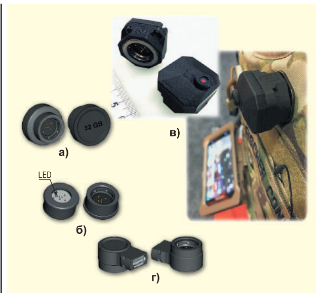
Рис. 4. Моноблочні пристрої на основі з'єднувачів Freedom для використання в екіпіровці Eleksen: флеш-накопичувачі (а); світлодіодні ліхтарі (б); адаптери інтерфейсів (в); мініатюрні USB 2.0 веб-камери (г)
