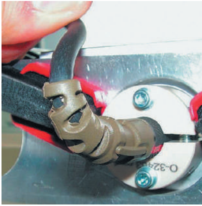
Рис. 2. Гнучкий хвостовик з'єднувача захищає кабель від пошкодження при згинах
