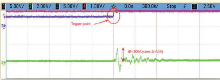
Рис. 10. Стрибок струму на емітері в момент включення транзистора
