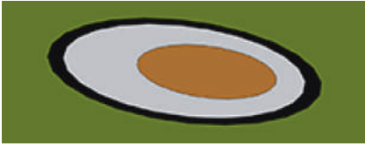
Рис. 6. Приклад зсуву перехідного отвору на верхньому шарі плати через плавлення термопласту
