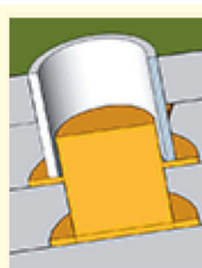
Рис. 10. Недостатня глибина висвердлювання, що залишає відвід в антенному ланцюгу
