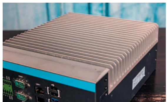
Рис. 2. Радіатор пасивного охолодження блоку Advantech MIC-730AI
