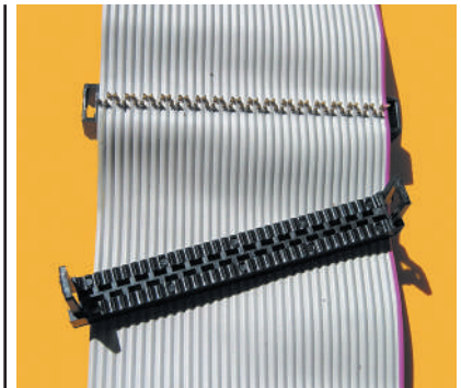
Рис. 4. Проколювання ізоляції стрічкового кабелю, а потім фіксація пластиковою планкою затискача
