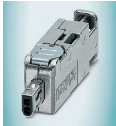
Рис. 2. Роз'єм SPE-T1-CIM-SF зі швидким з'єднанням IDC придатний для перетинів кабелю від 0.14 до 0.5 мм
