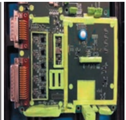
Рис. 5. Маскування компонентів на друкованій платі
