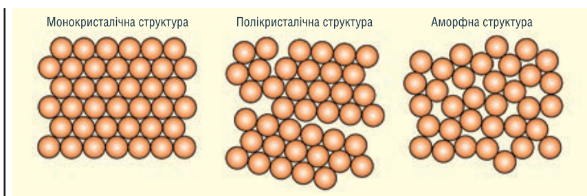
Рис. 22. Схематичне зображення орієнтації атомів у монокристалічних, полікристалічних та аморфних структурах
