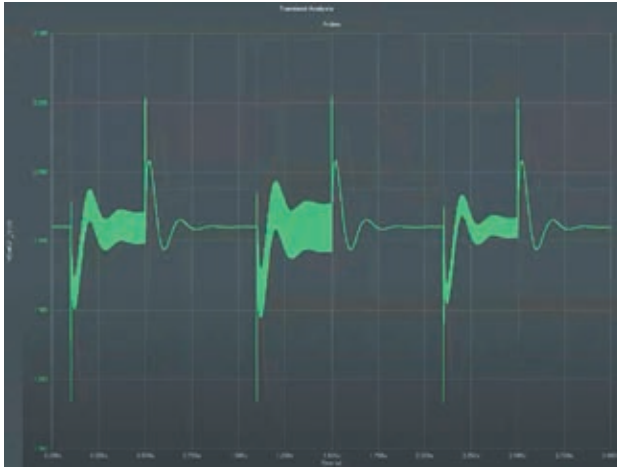
Рис. 2. Приклад результатів моделювання, що ілюструє тип коливань напруги на шинах, які можна спостерігати в часовій області
