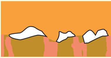
Рис. 1. Область контактування (а) і залежність контактної опору від кількості контактних точок (б)
