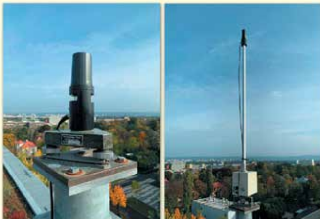
Рис. 9. Квадрифілярна спіральна антена в низькому (ліворуч) та високому (праворуч) положенні
