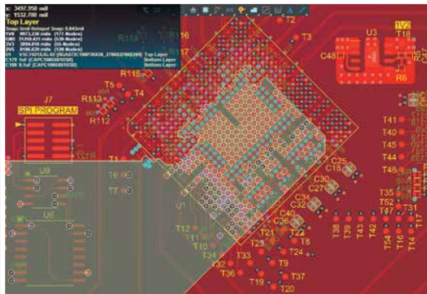
Рис. 1. Розгалуження матриці кулькових виводів на програмованій логічній інтегральній схемі з великим полігоном, що використовується для подачі живлення у високошвидкісному виконанні
