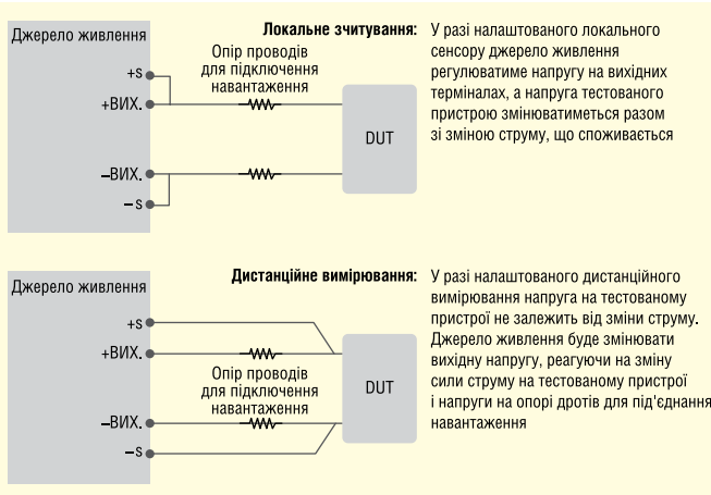
Рис. 1. Локальне та дистанційне вимірювання захисту від перевантаження за напругою
