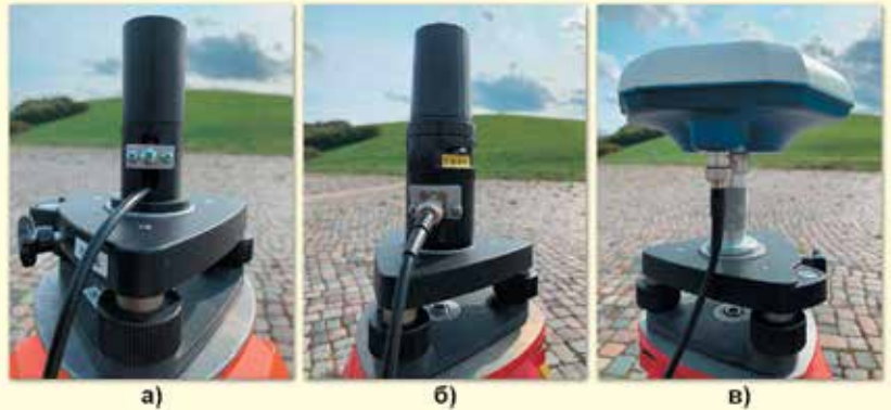
Рис. 1. Три типи антен, які були використані у дослідженні: Maxtena M7HCT (а); Tallysman HC975 (б); NavXperience 3G+C (в)
