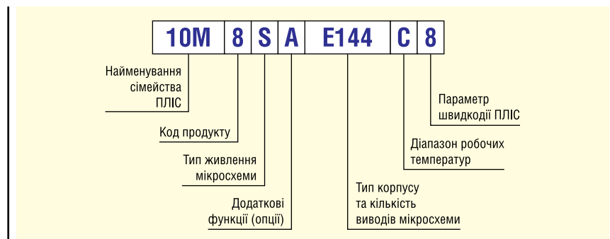
Рис. 2. Структура найменування ПЛІС сімейства MAX10
