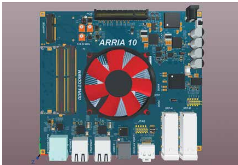
Рис. 3. Високошвидкісне компонування максимально ефективно, коли IC головного контролера розташована біля центру плати, з іншими високошвидкісними периферійними пристроями, розміщеними навколо неї. Це одна з причин, через яку материнські плати мають великий процесор, розташований у центрі плати
