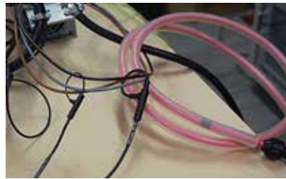
Рис. 2. Вимірювання синфазного струму за допомогою трьох різних поясів Роговського від РЕМ UK [8]. Ліворуч — РЕМ CWT Ultra mini; по центру — РЕМ CWT miniHF; праворуч — замовний РЕМ (дві обмотки)
