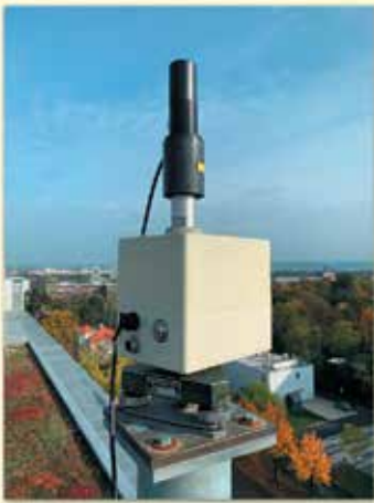
Рис. 11. Одна із QNA-антен на калібрувальному пристрої DRB2
