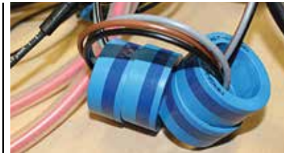
Рис. 4. Чотири послідовно з'єднаних кільцевих осердя з високою магнітною проникністю, що працюють як дроселі з компенсацією струму з двома обмотками
