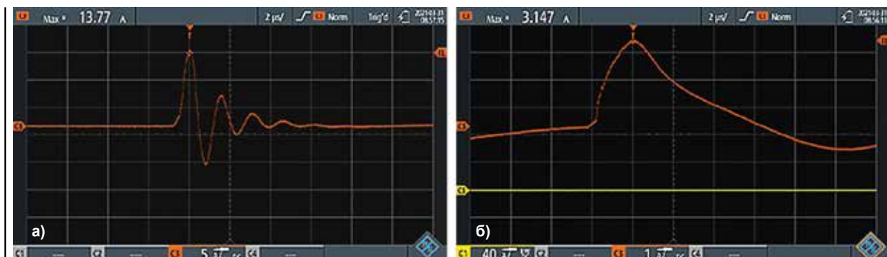
Рис. 5. Типова послідовність імпульсів синфазного струму: без захисних заходів (а); після встановлення струмових дроселів (б)
