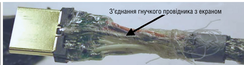
Рис. 9. Приклад поганого заправлення HDMI-кабелю
