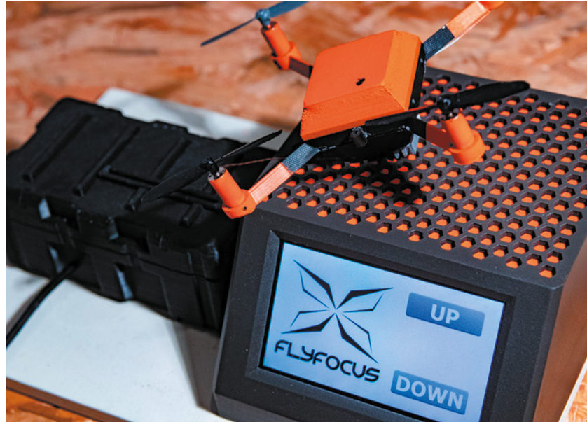
Рис. 3. Демонстраційний БПЛА використовує технологію ZVS
