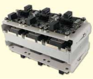
Рис. 4. Шасі «здвоеного силового ядра» XМ3 зі встановленими драйверами затворів забезпечує стабільність і ефективне проходження теплового потоку
