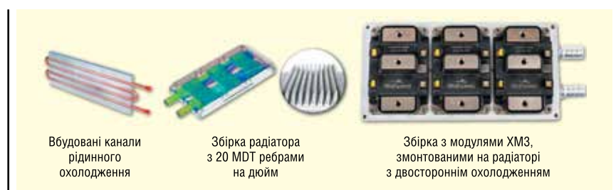
Рис. 3. Wolfspeed використовує радіатор із технологією мікродеформації MDT від WIELAND, що має 20 ребер на дюйм (у стандартних радіаторів 12 ребер на дюйм), що забезпечує зниження теплового опору і рівномірне охолодження
