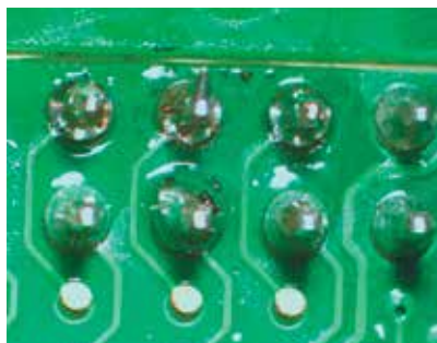
Рис. 8. Залишки флюсу на друкованій платі після паяння
