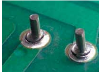
Рис. 9. Тріщини в пайці, що з'являються в процесі експлуатації
