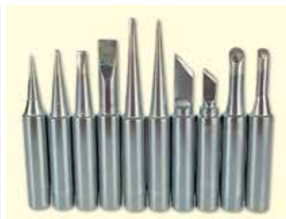
Рис. 3. Жала з різними типами робочих поверхонь
