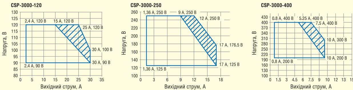
Рис. 5. Рекомендовані зони оптимальної ефективності (заштрихована область) для джерел живлення серії CSP-3000 у режимі стабілізації вихідного струму
