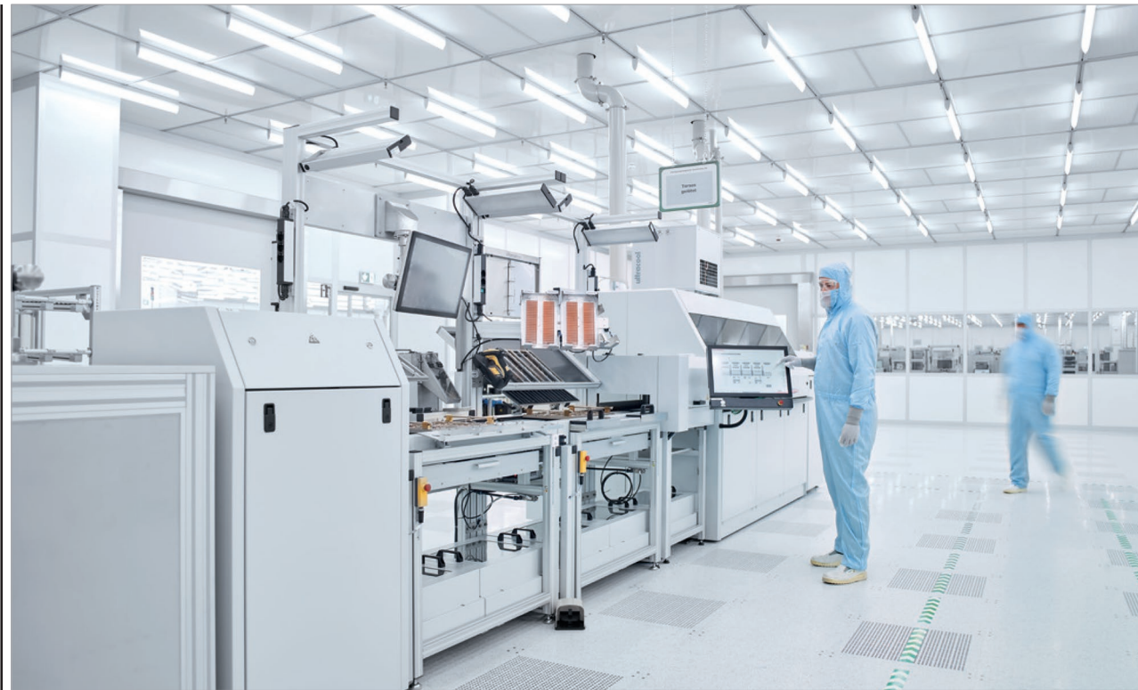
Рис. 10. Технологічна лінія монтажу та нанесення термопасту модулів SEMITOR
