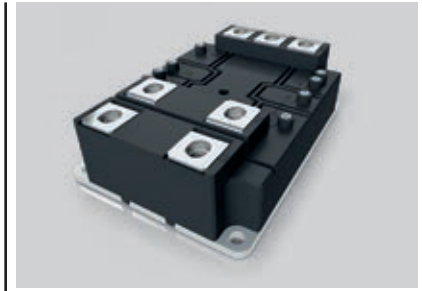
Рис. 3. Модуль SEMITRANS® 20 (від 500 кВА до 2 МВА)
