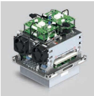
Рис. 8. Чотирифазний перетворювач з індивідуальним повітряним охолодженням (2 00А)
