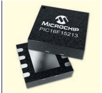
Рис. 1. Багато нових сімейств продуктів PIC і AVR пропонують різноманітні корпуси пристроїв VQFN роз міром 3 × 3 мм для застосувань з обмеженим простором
