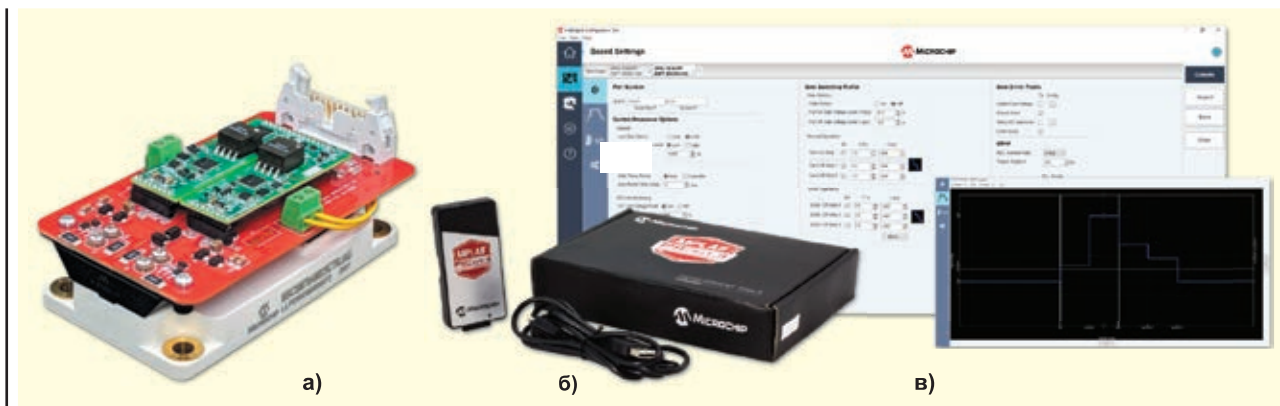
Рис. 15. Тестовий набір розробника: драйвер з адаптерною платою та карбід-кремнієвий силовий модуль (а); програматор (б) і спеціальне ПЗ (в)
