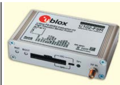
Рис. 1. Тестувальний комплект (комплект розробника) C102-F9R
