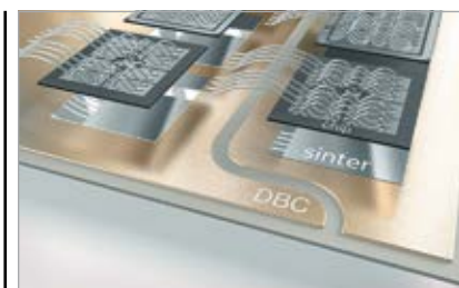
Рис. 4. Технологія для кріплення чипів спіканням
