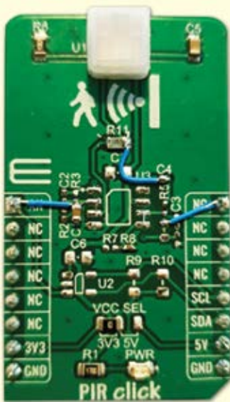
Рис. 3. Остаточний варіант електричної схеми використання датчика PIR спільно з МК сімейства ATtiny1627
