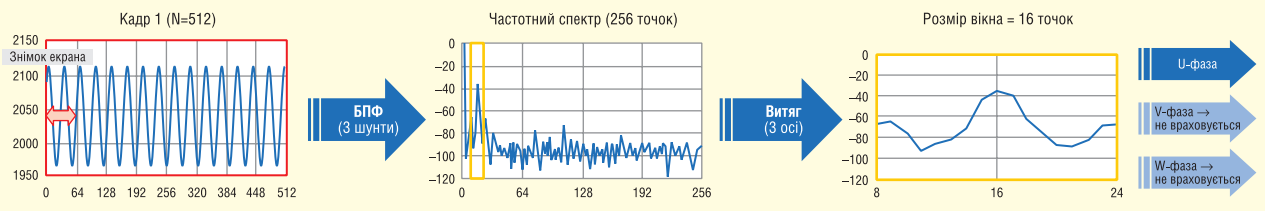
Рис. 5. Потік попереднього опрацювання даних від струмовимірювальних резисторів (шунтів) у вигляді аналогових даних до виділення артефакту піка частоти в спектрі
