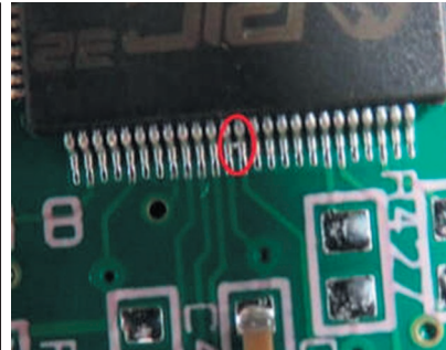
Рис. 9. Закоротка на виводах мікросхеми
