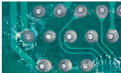
Рис. 7. Засохлий флюс на PCB
