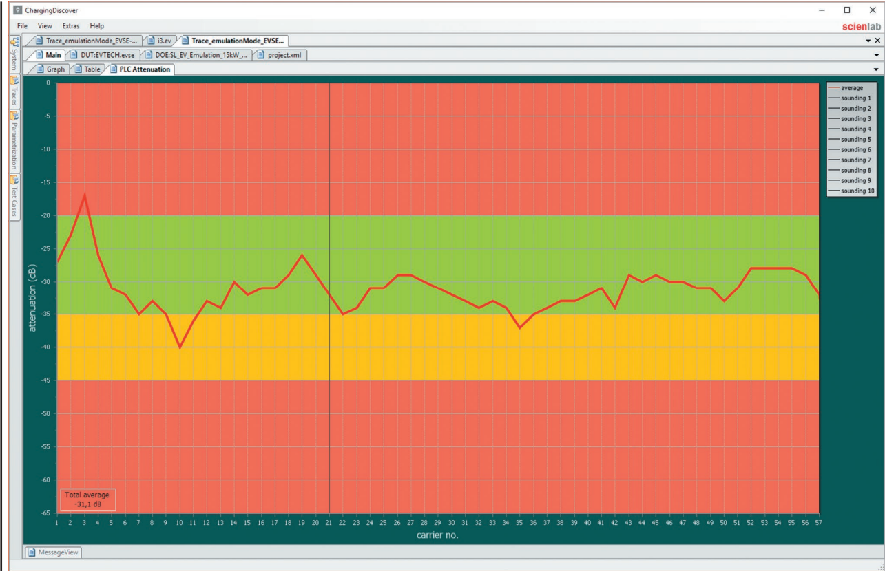
Рис. 6. Аналіз загасання сигналу в лінії електропередачі
