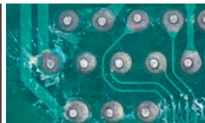
Рис. 7. Засохлий флюс на PCB
