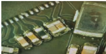
Рис. 13. Два конденсатори злиплись між собою на етапі запікання РСВА в пічці
