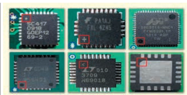
Рис. 3. Встановлення мікросхем по «ключу»
