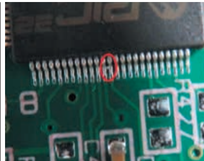
Рис. 9. Закоротка на виводах мікросхеми
