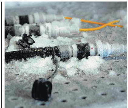
Рис. 2. ОЗ сімейства FiberOptic при випробуваннях за зниженої робочої температури
