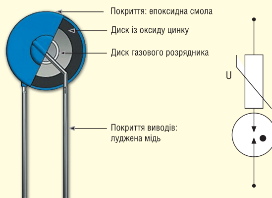
Рис. 5. Гібридний компонент для захисту від перенапруги GMOV компанії BOURNS
