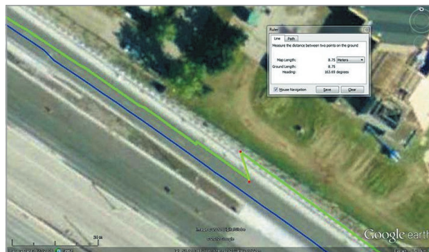
Рис. 10. Відхилення траєкторії системи на основі MEMС з OBDII
