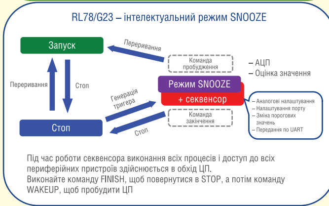
Рис. 5. Відмінності між мікроконтролерами RL78/G13 і RL78/G23
