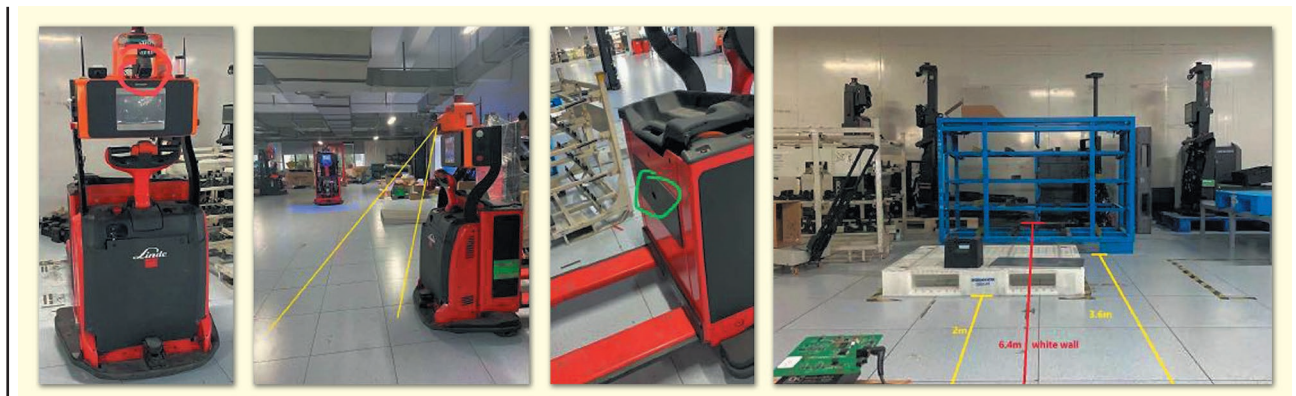
Рис. 6. Кадри випробувань автоматичного керування навантажувачем на основі двох iToF-камер на базі сенсора Gpixel GTOF0503
