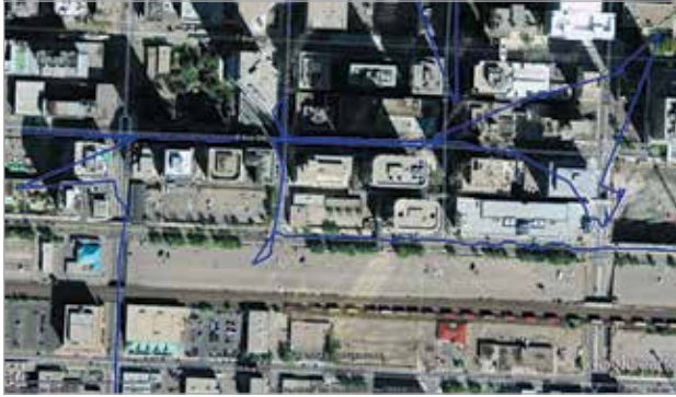
Рис. 2. Результати визначення місцезнаходження, що надаються рішенням на основі GPS з багатопроменевим поширенням
