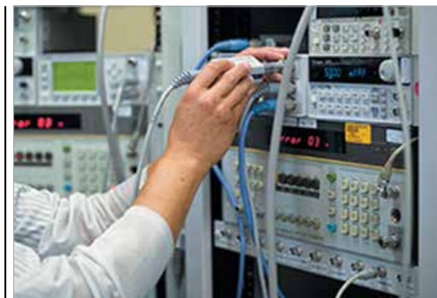
Рис. 1. Встановлення цифрового мультиметра у виробничу випробувальну систему
