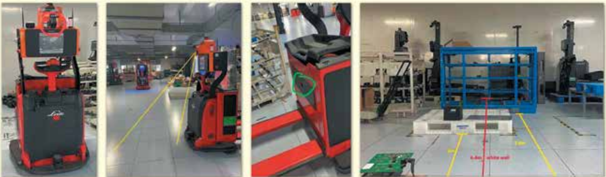
Рис. 6. Кадри випробувань автоматичного керування навантажувачем на основі двох iToF-камер на базі сенсора Gpixel GTOF0503
