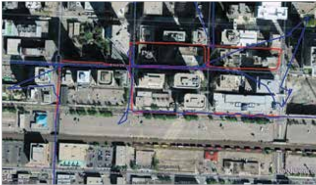
Рис. 3. Траєкторія руху рішення на основі BOG і GPS (червоним кольором показано траєкторію з працюючими BOG і приймачем GPS, синім кольором — тільки з працюючим приймачем GPS)
