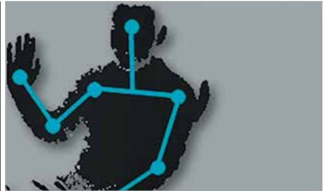
Рис. 5. Приклад розпізнавання жестів водія (джерело: Sony Depth Sensing website)
