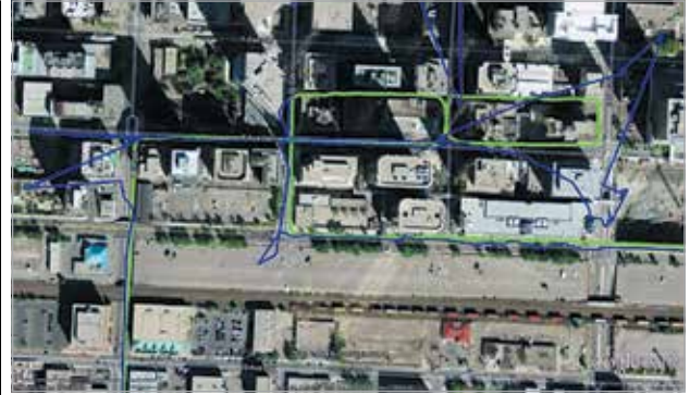
Рис. 5. Траєкторія руху рішення на основі MEMS, GPS і OBDII (зеленим кольором показано траєкторію з працюючими MEMS, приймачем GPS і системою OBDII, синім кольором — тільки з працюючим приймачем GPS)
