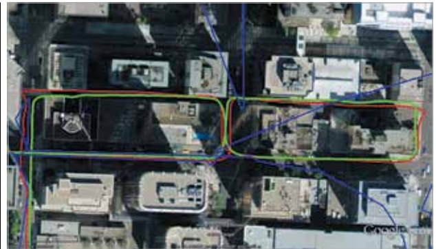
Рис. 6. Траєкторія системи на основі MEMS з OBDII (показана зеленим кольором), траєкторія системи на основі BOG без OBDII (показана червоним кольором) і траєкторія системи тільки з працюючим приймачем GPS (показана синім кольором)
