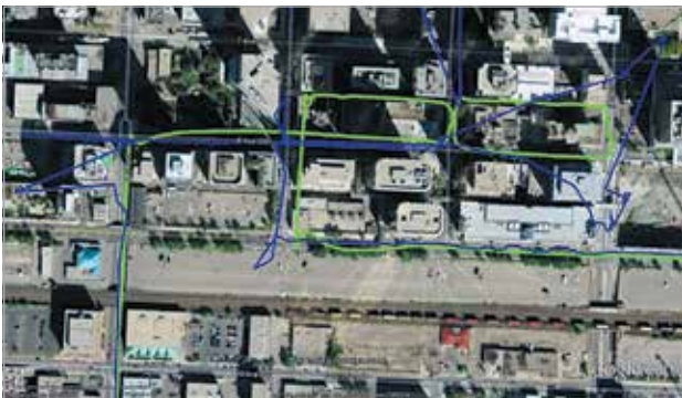
Рис. 4. Траєкторія руху рішення на основі MEMS і GPS (зеленим кольором показано траєкторію з працюючими MEMS і приймачем GPS, синім кольором — тільки з працюючим приймачем GPS)
