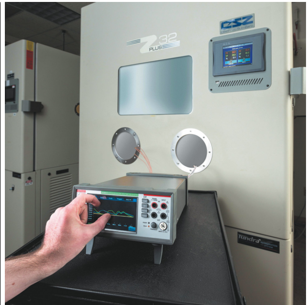
Рис. 7. У реєстратори даних можна вбудувати карти мультиплекторів та сканувальні плати для відстеження процесів та сигналів у виробничому середовищі
