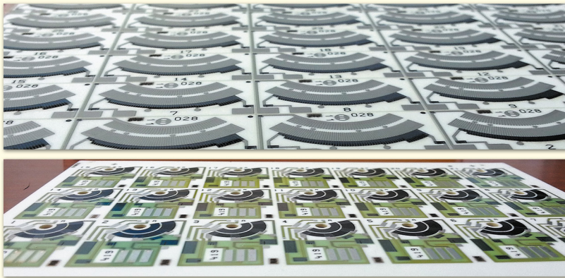
Рис. 3. Приклад керамічної друкованої плати із вбудованими компонентами
