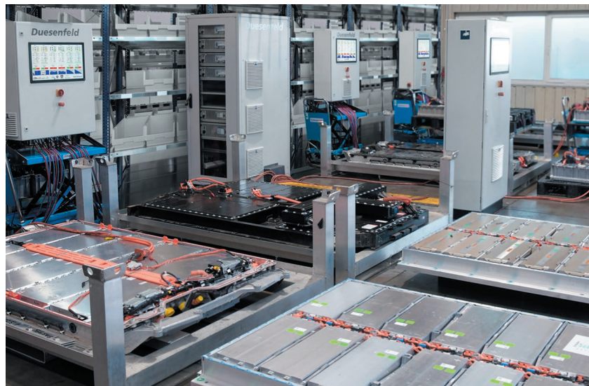
Рис. 3. Акумуляторні батареї електромобілів розряджаються перед демонтажем. На передньому плані можна побачити окремі повністю зварені акумуляторні модулі
