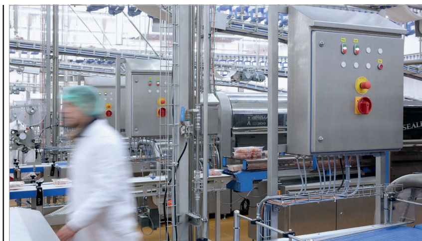
Рис. 1. Приклад використання шаф AX HD в харчовій промисловості
