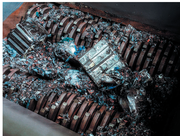
Рис. 4. Подріблення батарейних модулів або — залежно від конструкції — цілих батарейних блоків представляє сучасний рівень техніки у технології переробки батарей
