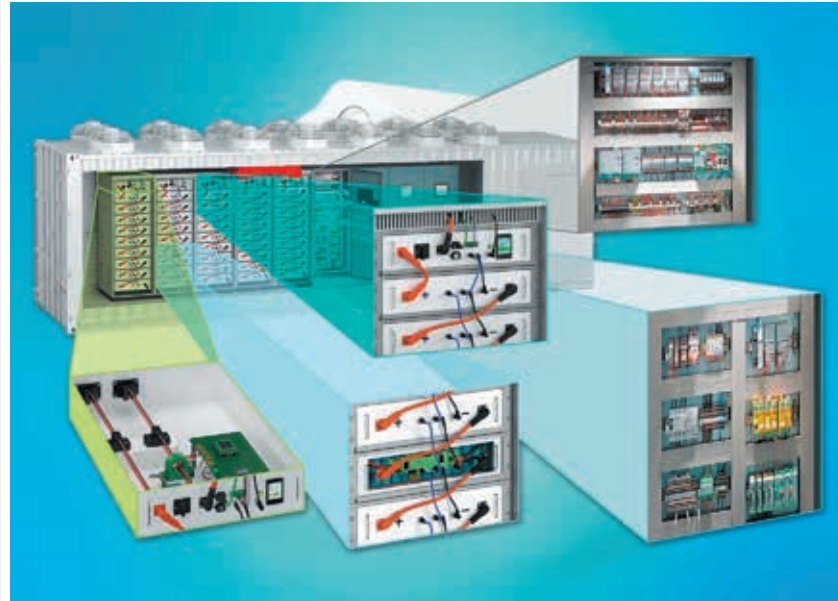
Рис. 2. Модульність акумуляторних систем — від елемента через блок до системи
