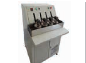
Автомат для полірування пластин
