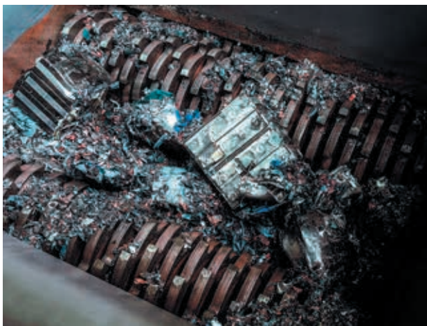
Рис. 4. Подріблення батарейних модулів або — залежно від конструкції — цілих батарейних блоків представляє сучасний рівень техніки у технології переробки батарей
