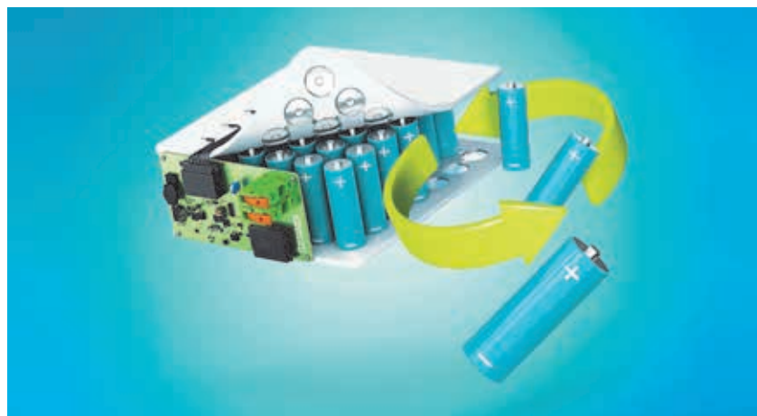
Рис. 1. В даний час, як правило, неможливо повністю розібрати батарею на компоненти, частково тому, що окремі елементи нерозривно пов'язані один з одним
