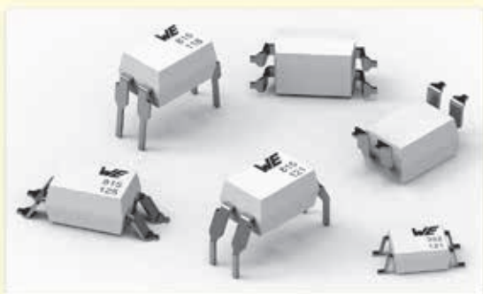
Рис. 5. Зовнішній вигляд і схема електрична принципова оптронів WL-OCDA серії 815 компанії Würth Elektronik
