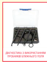
Рис. 5. Використання пробника ближнього поля для локалізації джерела випромінювань у пристрої
