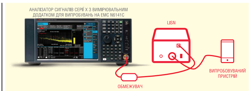
Рис. 4. Схема вимірювань рівня кондуктивних завад з використанням обмежувача перехідних завад та еквівалента мережі (LISN)
