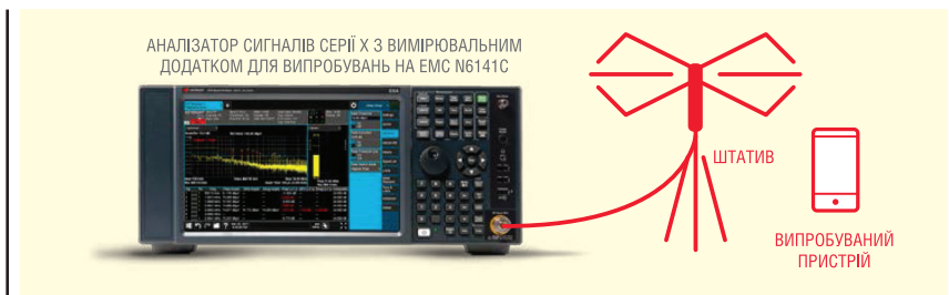
Рис. 3. Схема вимірювання рівня власних електромагнітних випромінювань пристрою
