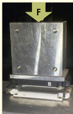
Рис. 3. Ліворуч: установка для перевірки механічної міцності. Праворуч: ескіз тестової установки з EconoDUAL 3 (внизу) та EconoDUAL 3 Black Series (вгорі). Модулі з'єднані за допомогою металевої шини на силових терміналах, зусилля прикладено по центру зверху (зелена стрілка)
