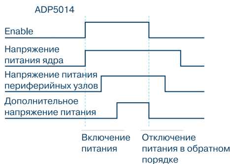
Рис. 3. Временные диаграммы работы многоуровневого источника питания ПЛИС FPGA
