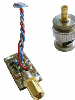
Рис. 2. Внешний вид портативного генератора белого шума
