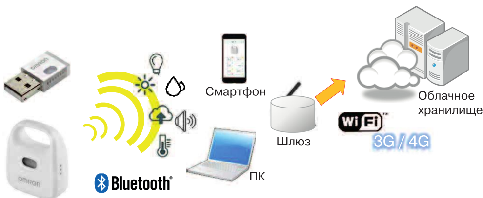
Рис. 3. Подключение датчиков 2JCIE-VU01 и 2JCIE-BL01 к облачному хранилищу через интерфейс Bluetooth® low energy
