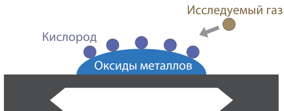
Рис. 6. Иллюстрация принципа действия датчика летучих органических соединений
